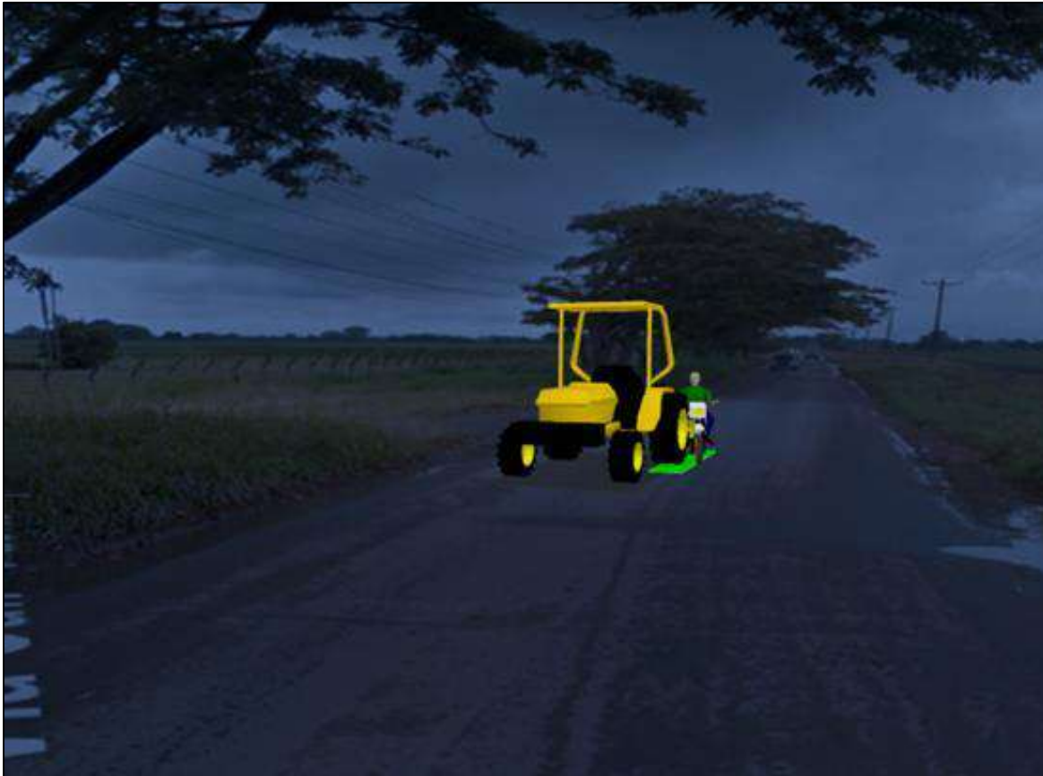
IMAGEN No. 19: En esta imagen en Edge foto FX se muestra la posición relativa de los vehículos al momento del impacto, y el área de color verde donde se presentó la colisión.
