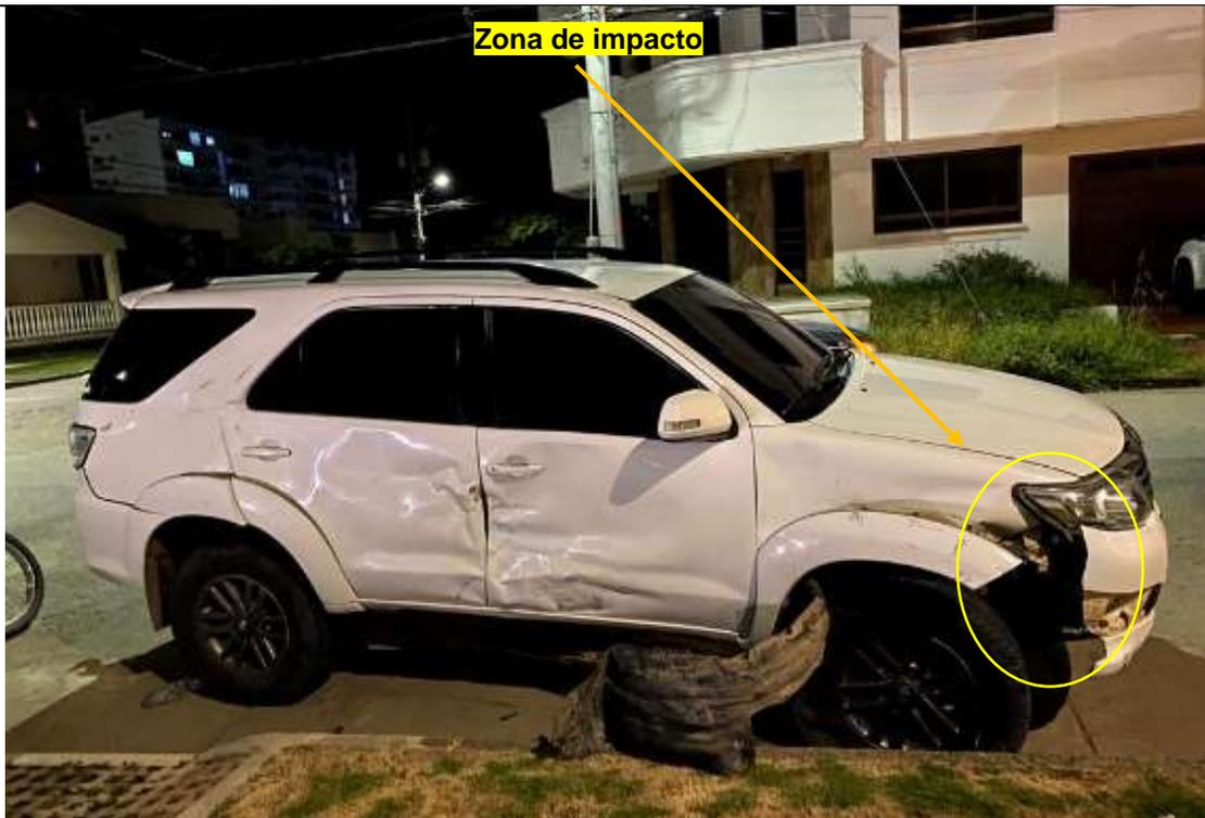
En la imagen anterior se observa el tercio anterior lateral derecho, donde evidencia hundimiento del guardabarros debajo del vértice de la farola, partidura del bomper en el costado derecho, protector interno del guardabarros fuera de su posición normal, hundimientos y abolladuras en las láminas de las puertas lateras del lado derecho.
