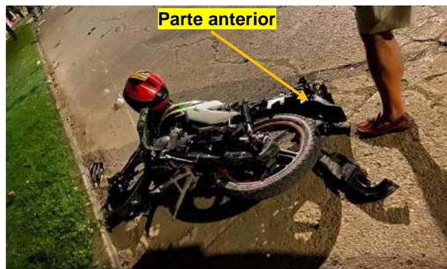
En la imagen anterior se observa la parte trasera de la motocicleta, guardabarros, llanta y ring, amortiguadores en su posición normal, no se observa destrucción o deformación en la parte trasera que nos indique que la motocicleta recibió un impacto en la trasera. (fotografía tomada momentos después del accidente por testigos)
