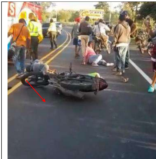
Fotografía 9. (tomada en sentido Cerete - La Ye) Posición final de la motocicleta Suzuki Hayate evolution placas FEA88E (sobre el costado derecho). Se ilustra una huella de origen metálico (evoluciona separándose de las líneas amarillas dobles).
