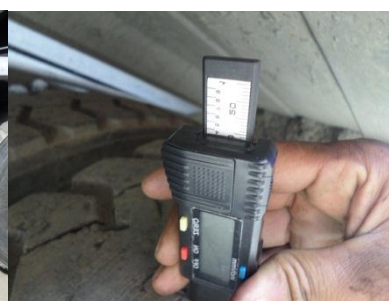
SEGUNDO EJE LLANTA IZQUIERDA TRASERA CON DESGASTE AL 60%
