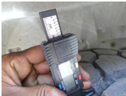
PRIMER EJE LLANTA IZQUIERDA DELANTERA CON DESGASTE AL 60%
