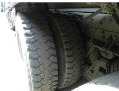
SEGUNDO EJE LLANTA IZQUIERDA TRASERA CON DESGASTE AL 60%
