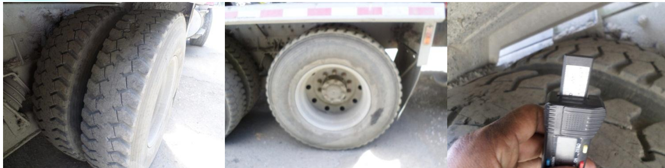
SEGUNDO EJE LLANTA DERECHA TRASERA CON DESGASTE AL 60%
