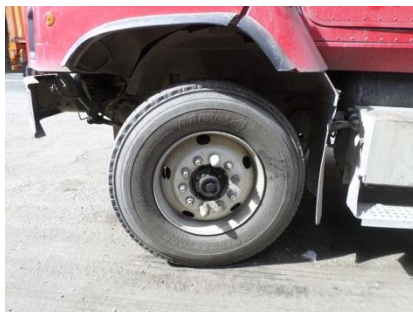
PRIMER EJE LLANTA IZQUIERDA DELANTERA CON DESGASTE AL 60%
