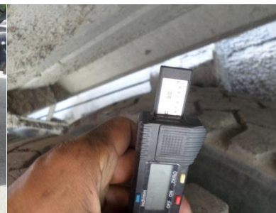
TERCER EJE LLANTA IZQUIERDA TRASERA CON DESGASTE AL 60%
