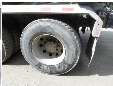
TERCER EJE LLANTA IZQUIERDA TRASERA CON DESGASTE AL 60%
