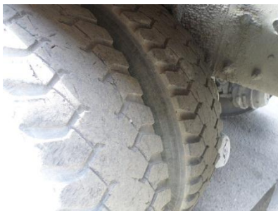
TERCER EJE LLANTA IZQUIERDA TRASERA CON DESGASTE AL 60%
