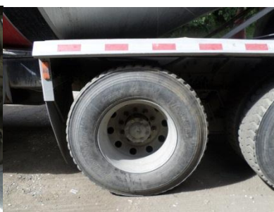
SEGUNDO EJE LLANTA IZQUIERDA TRASERA CON DESGASTE AL 60%
