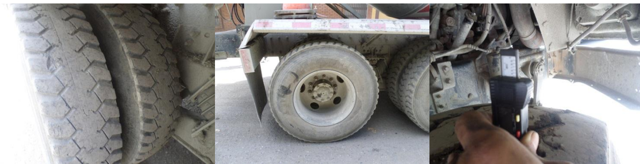
TERCER EJE LLANTA IZQUIERDA TRASERA CON DESGASTE AL 60%
