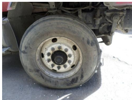
PRIMER EJE LLANTA DERECHA DELANTERA CON DESGASTE AL 60%
