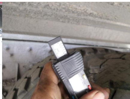
PRIMER EJE LLANTA DERECHA DELANTERA CON DESGASTE AL 60%
