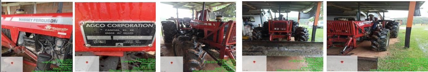
**OBSERVACIONES:** Se realizó la inspección en marcha del tractor, el cambio # 3 no le sirve. Problemas en la prensa al embragar.
