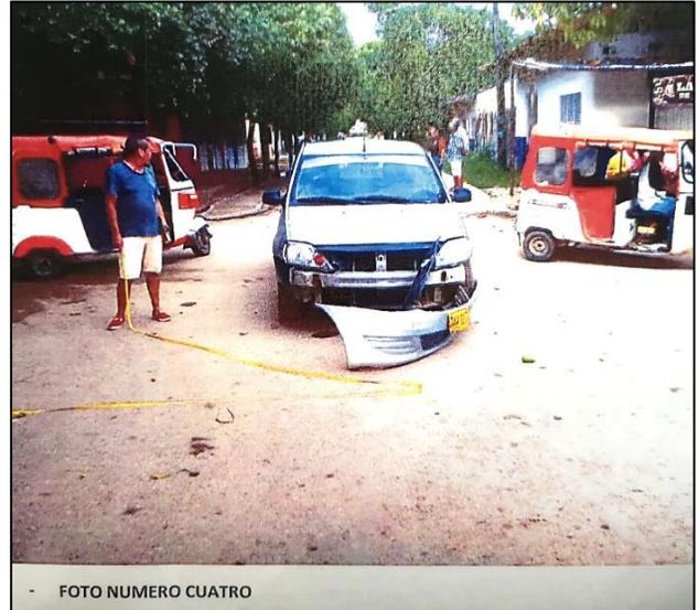
En las fotografías tres y cuatro, obrantes a Folio 5, se evidencian los daños causados por parte del motociclista, que consisten en el desprendimiento del *bumper* del vehículo, el cual ocurrió porque la “pata” o “taco” de la motocicleta se enganchó en la parte derecha del *bumper* en el trayecto de la maniobra peligrosa realizada por el Sr. JOSÉ CÁNDIDO DÍAZ, tal como lo corrobora el dictamen pericial.
