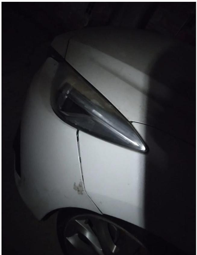
En la fotografía 10 se muestra el desprendimiento del bomper delantero del tanque de la gasolina.
