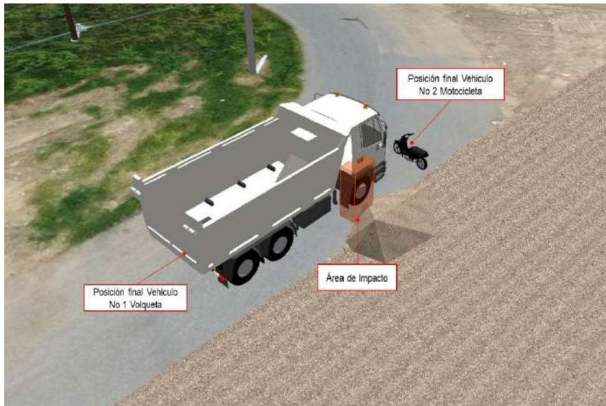
**Imagen No. 22:** En esta imagen en 3D, se observa la secuencia del accidente, nótese el sentido de desplazamiento de los vehículos, el área de impacto de color naranja. Elaborada en el software Trimble Forensic Reveal.
