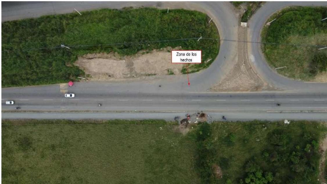
**Fotografía No. 1 Aérea:** fotografía tomada en planta de la vía Candelaria – Cali km 0 + 800 , donde se observan las características generales del tramo de vía recta, plana, estado bueno, una calzada donde ocurren los hechos, único sentido de circulación.
