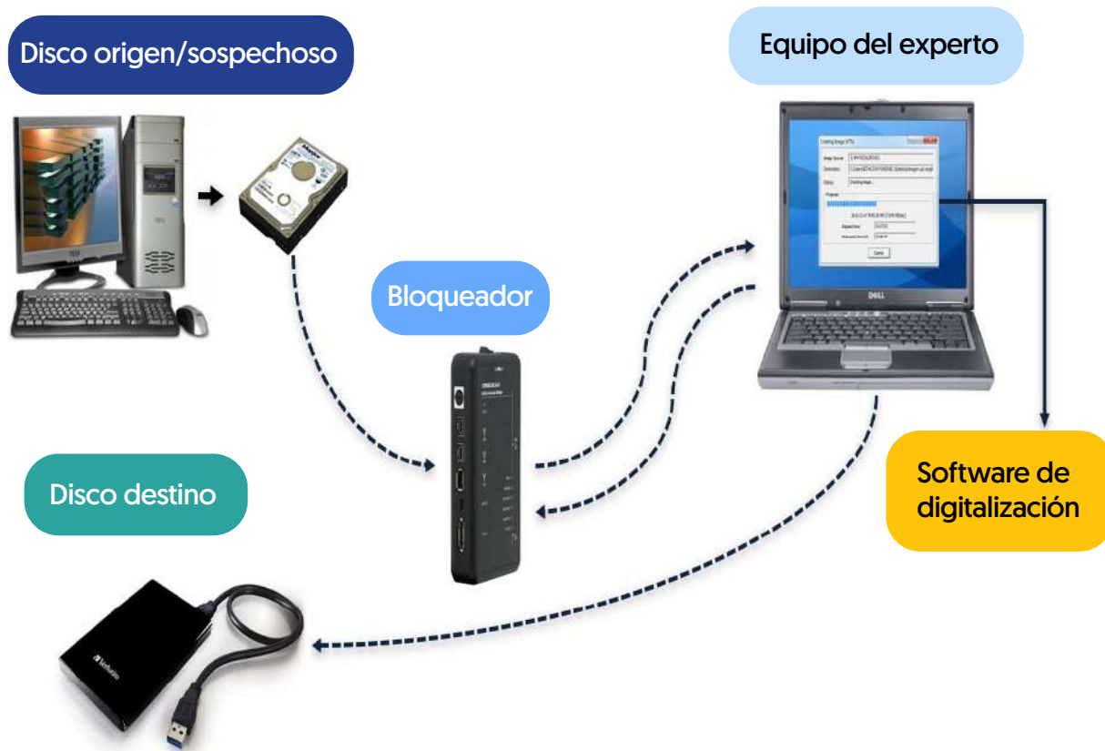
Ilustración 2. Realización de imagen forense
