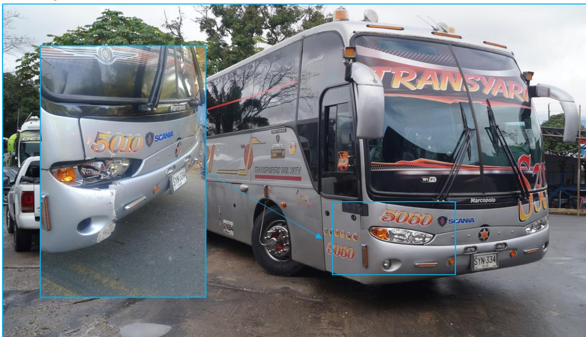
IMAGEN 14. En esta imagen se referencia rotura de bomper y rotura en unidad de luz zona anterior lateral derecha inferior.
