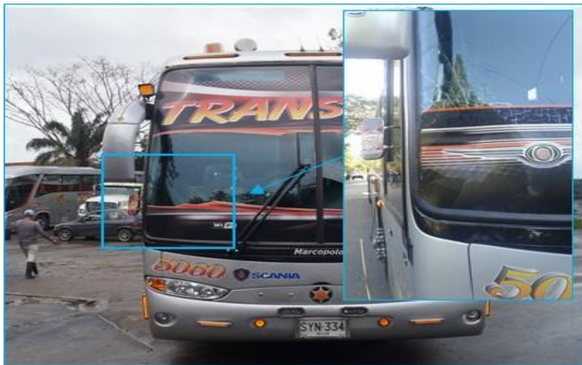
IMAGEN 15. En esta imagen se referencia poli fragmentación en costado lateral derecho del panorámico en zona anterior del vehículo No. 1 bus.
