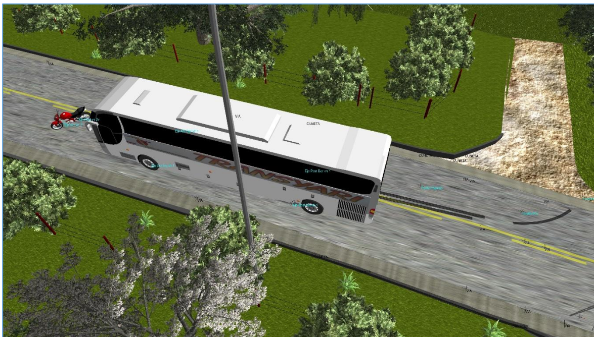
IMAGEN 3. Imagen en 3D, vista desde otro ángulo y tomada del software de reconstrucción Edge FX. A partir de la nube de puntos obtenida durante la investigación de campo.
