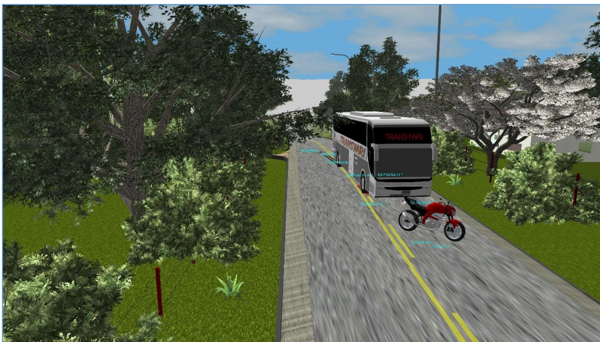
IMAGEN 2. Imagen en 3D, tomada del software de reconstrucción Edge FX. A partir de la nube de puntos obtenida durante la investigación de campo.
