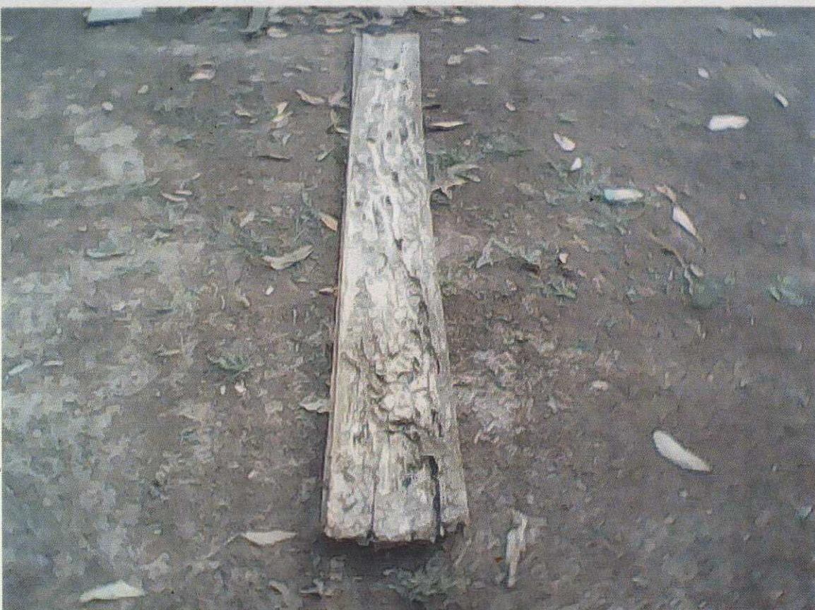
biga de madera totalmente demolida por el comején por falta de fumigación de insecticidas
