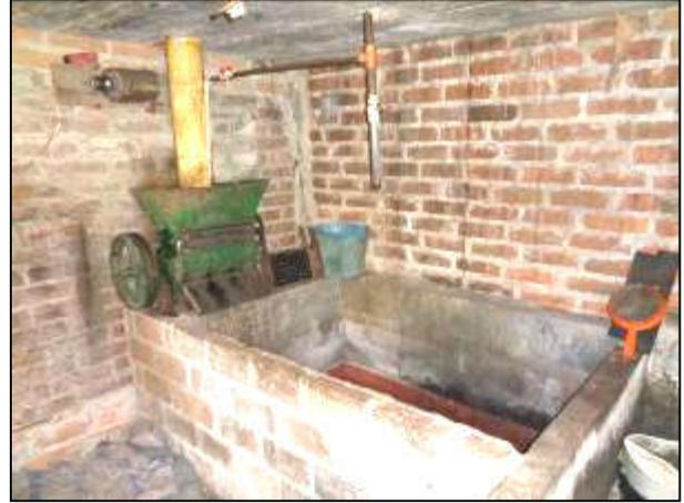
**DESPULPADORA - TANQUES DE LAVADO**
