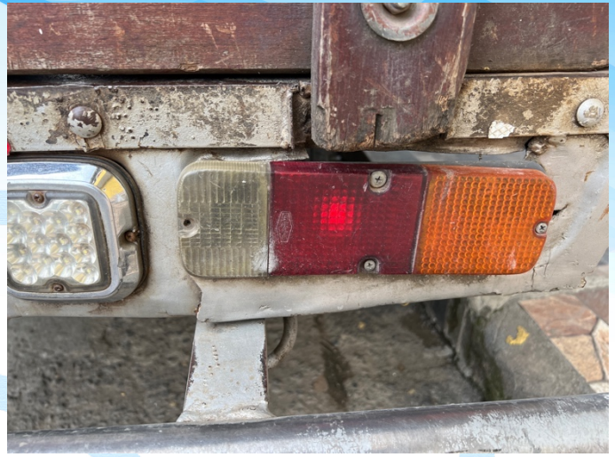
Imagen Nº 10: se evidencia parte posterior, se ubica el conjunto del stop, regular estado de conservación regular estado de funcionamiento.
