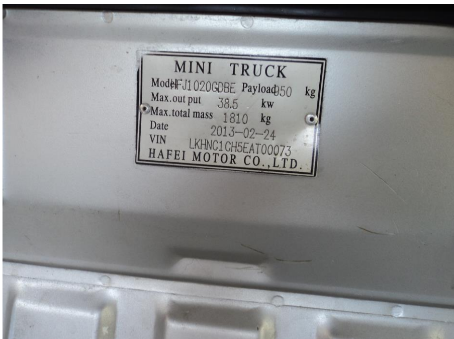
Nº 1.- Plaqueta que identifica la marca, el modelo, fabricación, V.I.N,etc.
