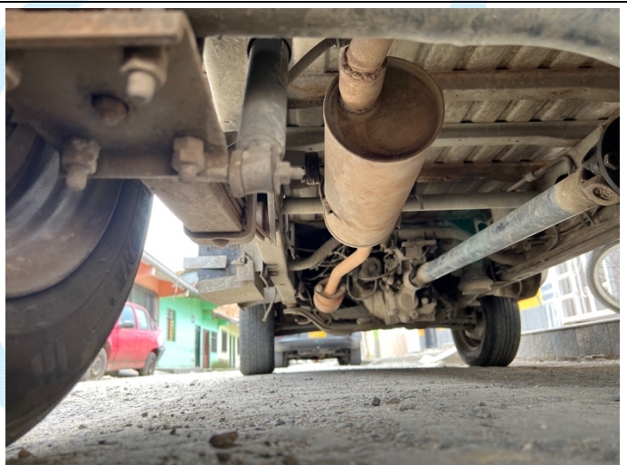
Imagen Nº 12: se evidencia parte inferior, donde se aprecia la salida del tubo de escape, elemento el cual evidencia un buen estado de conservación y buen estado de funcionamiento, evidencia que este elemento ha sido remplazado.
