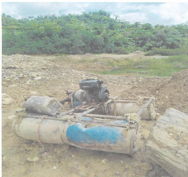
Evidenciamos un motor que bombea el agua para el lavado del material.
