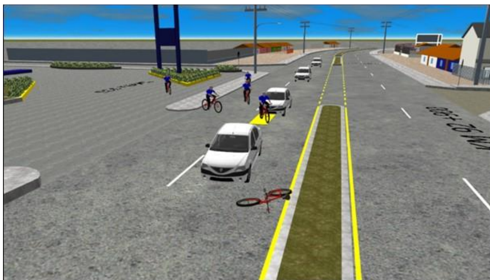
IMAGEN No. 18: Imagen en 3D de la secuencia establecida para el evento, donde se plasman las rutas de circulación, el impacto y el desplazamiento hasta las posiciones finales.
