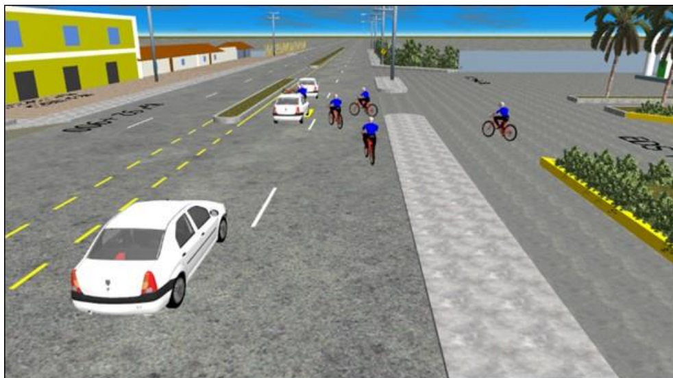
IMAGEN No. 19: Imagen en 3D de la secuencia establecida para el evento, donde se plasman las rutas de circulación, el impacto y el desplazamiento hasta las posiciones finales.
