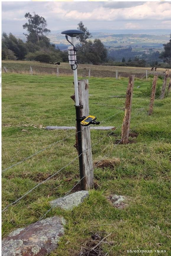
Equipo con el que se realizó el levantamiento topográfico.
