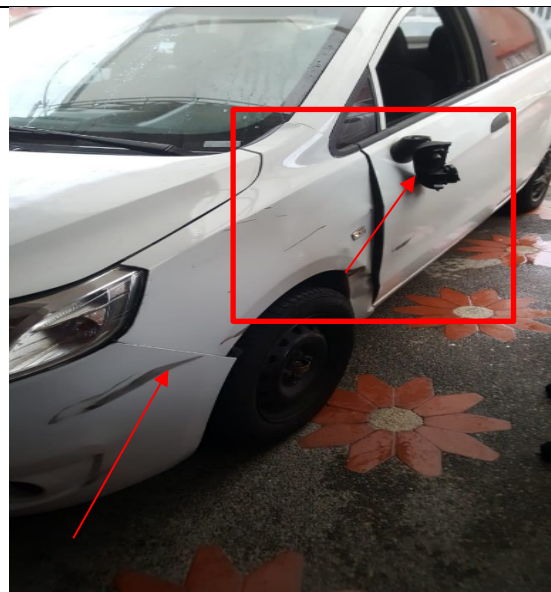
IMAGEN 2 fotografía que refleja el punto de impacto lateral de la moto sobre todo el guardabarro izquierdo, retrovisor izquierdo y puertas laterales izquierdas
