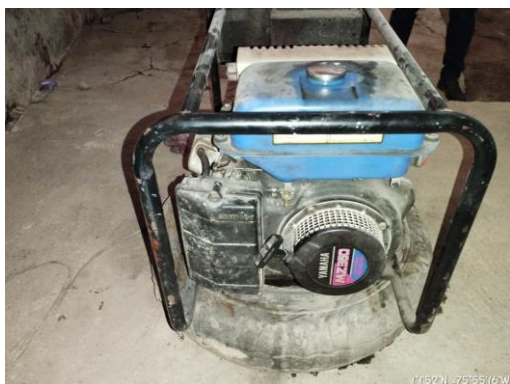
Planta eléctrica yamaha motor m2360 de 6200w
