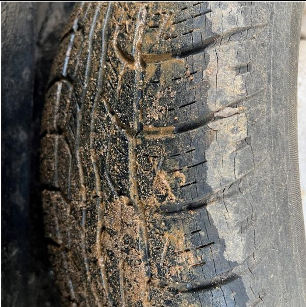
**Imagen N° 29:** neumáticos posteriore izquierdo se evidencia un regular estado
