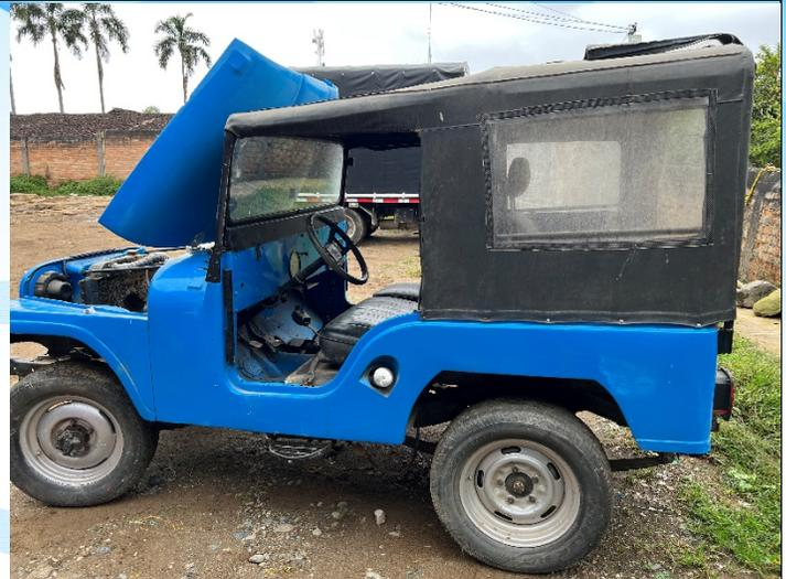
Imagen N° 4: se aprecia parte lateral izquierda, no se evidencia puerta de ingreso, pintura en buen estado, regular estado del tablero de instrumentos y de palanca de cambios.
