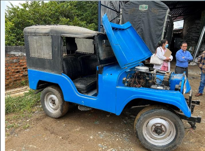
Imagen N° 3: se evidencia parte lateral, se evidencia un buen estado de la pintura, no presenta las puertas del carro, la carpa esta en regular estado, no presenta el bomper.
