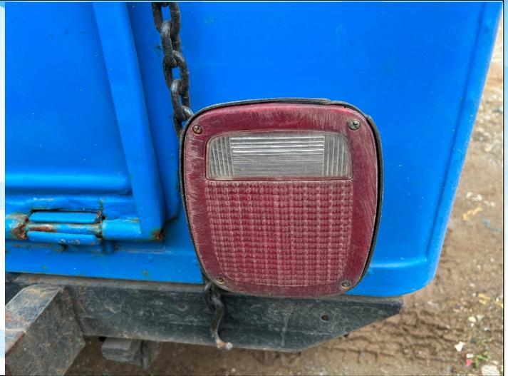
**Imagen N° 12:** conjunto lumínico posterior derecho, Buen estado de conservación pero no funciona
