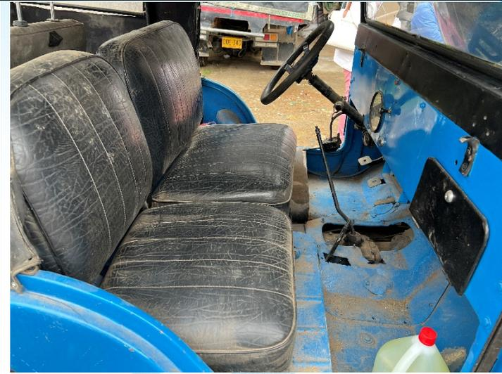
**Imagen N° 7:** se ubica parte interior, regular estado de conservación, las palancas cambios no presentan la bola de manejo, no tiene el protector de la caja de cambios, cojinería en mal estado.
