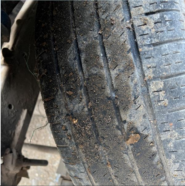
**Imagen N° 27:** neumático anterior derecho evidencia un regular estado
