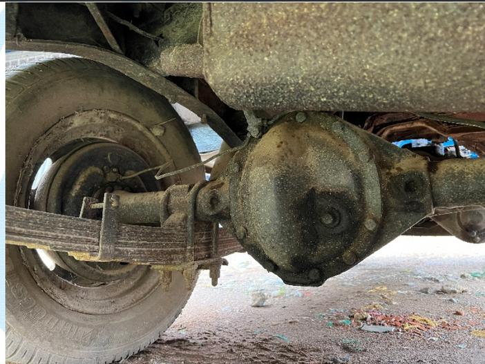
**Imagen N° 26:** se evidencia el diferencial trasero, presenta un regular estado de conservación no se determino su funcionamiento.
