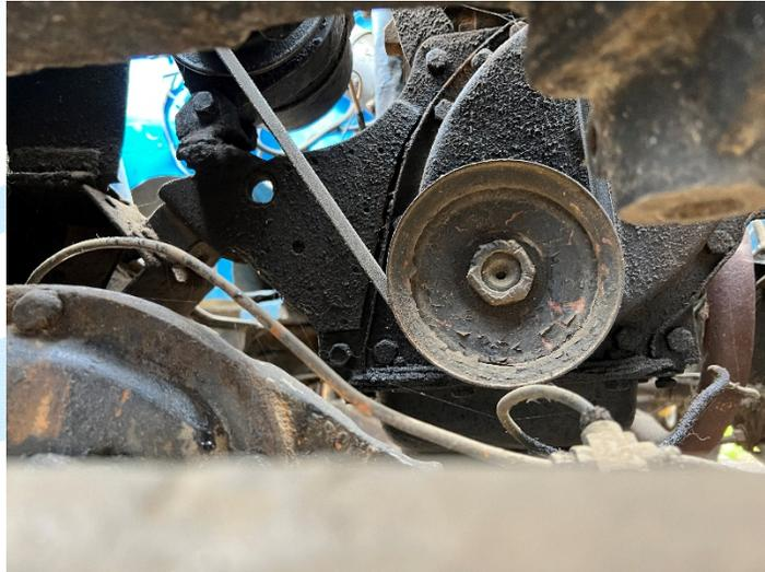
**Imagen N° 21:** se ubica parte interna del motor, presenta fuga de aceite y presencia de óxido, conjuntos en regular estado.
