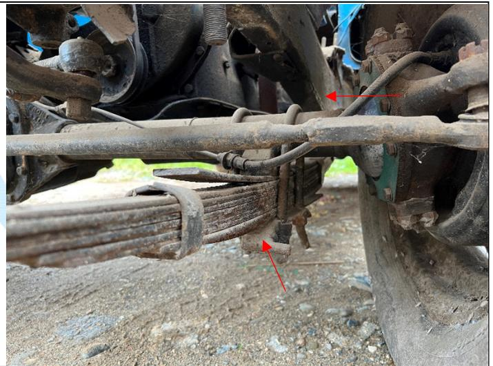
**Imagen N° 22 y 23:** se evidencia parte inferior del automotor, el cual se aprecia, sistemas de amortiguación y conjuntos de dirección, componentes en regular estado, presenta óxido en sus componentes.
