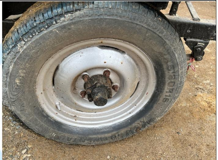
**Imagen N° 14:** conjunto de rodamiento anterior derecho buen estado
