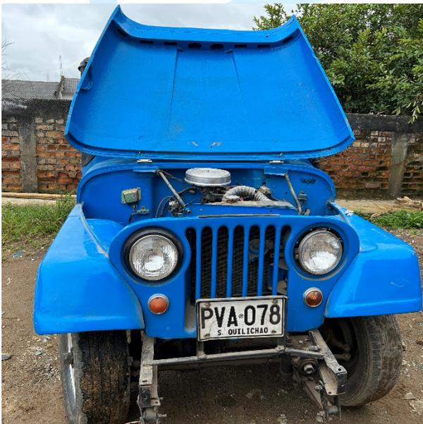
**Imagen N° 1:** se aprecia parte anterior del rodante, no se ubica el pomper delantero, regular estado de algunos componentes. Pintura en buen estado.
