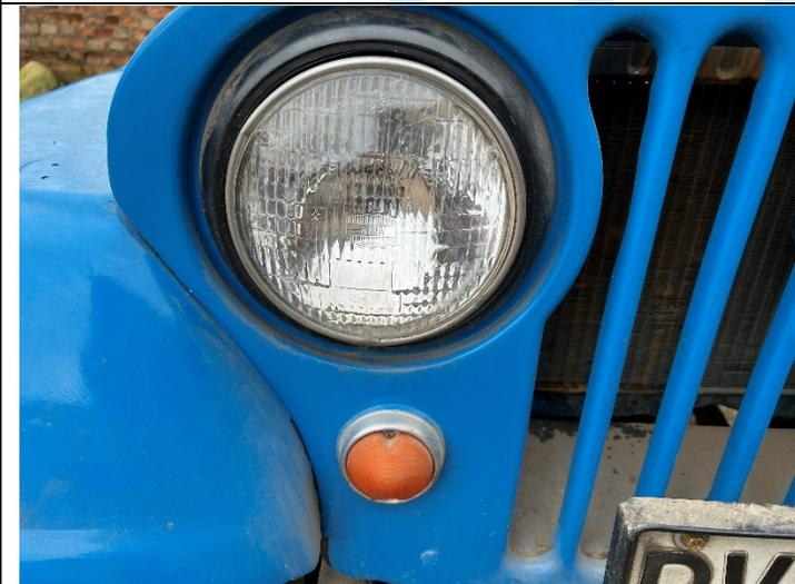
Imagen N° 5: se aprecia conjunto lumínico anterior derecho, se observa buen estado de sus elementos
