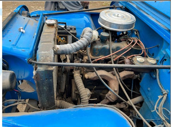
Imagen N° 15, 16, 17 y 18: se observa conjunto motor del vehículo, el cual se aprecia un regular estado de conservación, al examinar las partes se encontró que si prende y funciona correctamente el moto.
