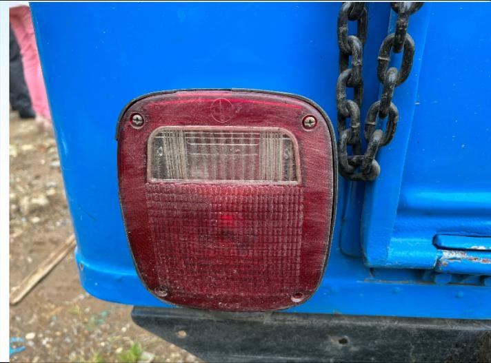
**Imagen N° 11:** conjunto lumínico posterior izquierdo, buen estado pero no funciona
