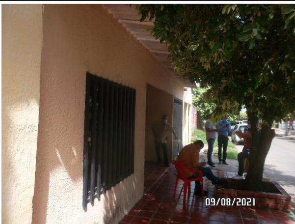
**Fachada en bloque de cemento, pañetada, pisos de andenes y terraza, en tableta de gres. Techo cubierto enteja ondulado tipo eternit. Al frente, hay sembrado un árbol de olivo para sombri y ambientación de la vivienda y la ciudad**
