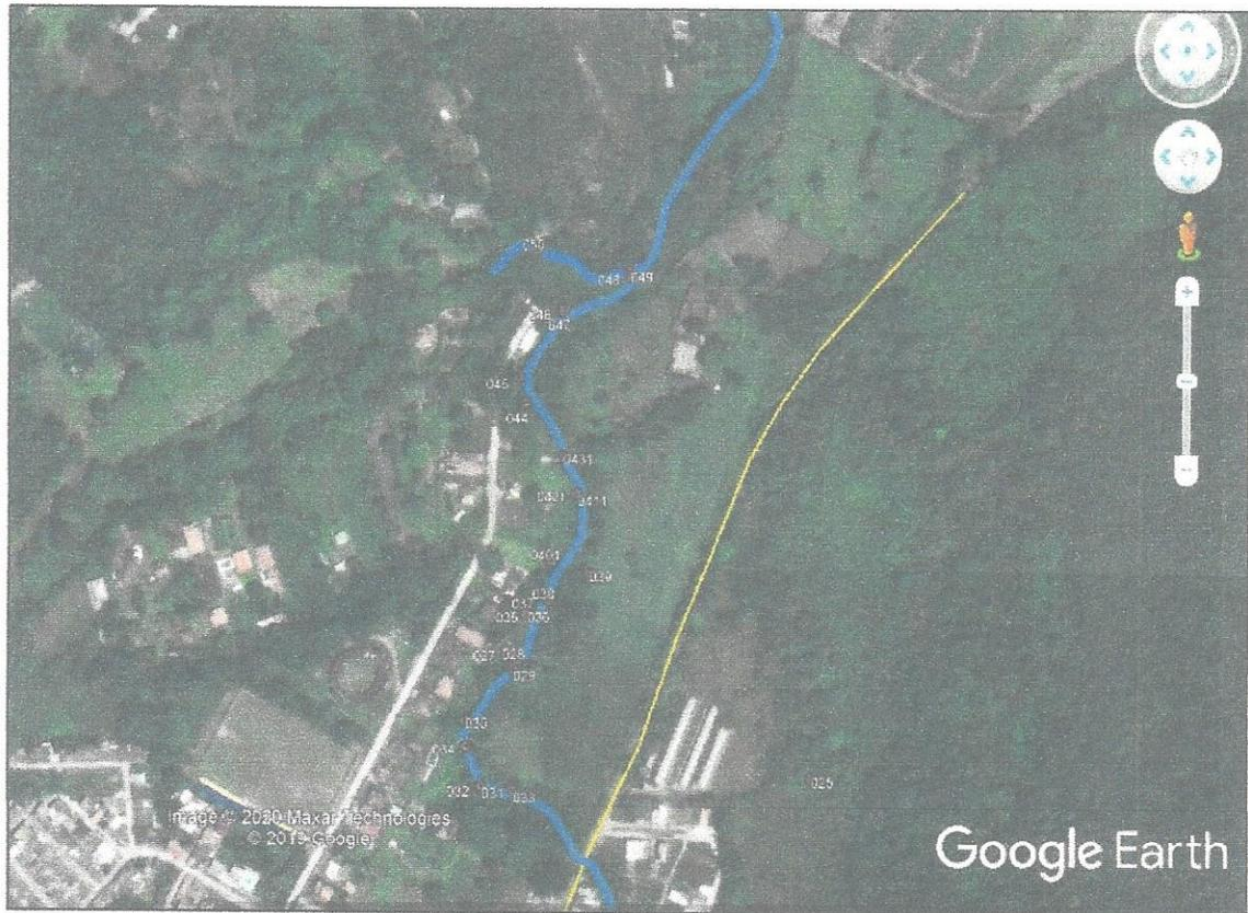
En la imagen se puede observar de color azul el recorrido de la quebrada AGUABLANCA y de color amarillo la VÍA, lo cual a simple vista nos permite determinar que existe un error con respecto al levantamiento topográfico tomado como base para el loteo que dio origen jurídico al predio denominado PEQUEÑO LOTE LONGITUDINAL N° 2 y a los pequeños lotes longitudinales colindantes, el cual también es muy similar a la información catastral.
