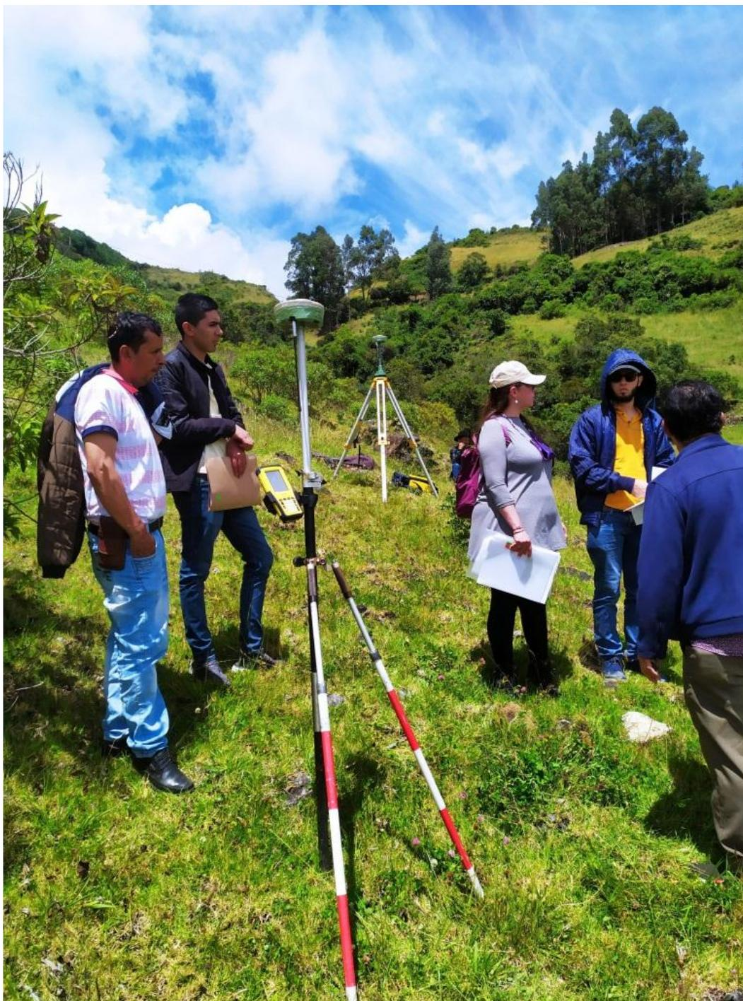
FOTOGRAFIA 5 (Equipo Topográfico Satelital Doble Frecuencia GNSS).
