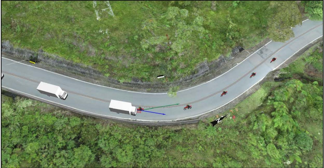
Figura 33. Reconstrucción trayectorias pre-impacto y posición relativa durante la colisión.
