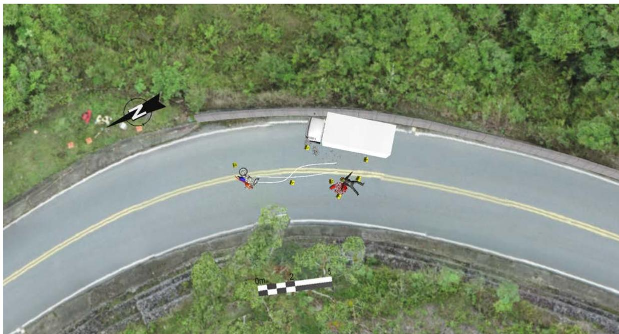
Figura 22. Plano cenital, reconstrucción posición final de los EMP y EF. La demarcación de doble línea continua amarilla fue registrada fotográficamente durante la inspección al lugar de los hechos por parte del suscrito perito; sin embargo, para el día de los hechos, la calzada no presentada esta demarcación vial.
