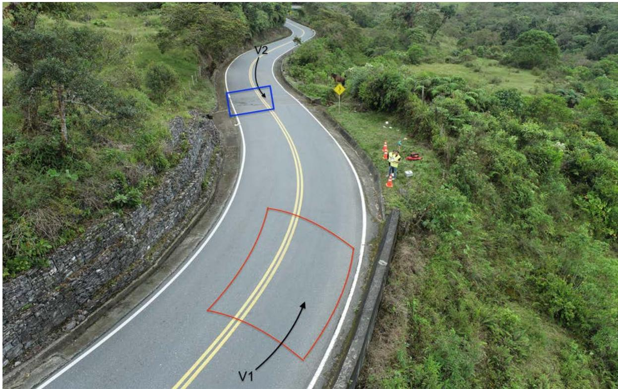
Figura 7. Panorámica de la vía, con vista hacia el norte, en la trayectoria del vehículo (1) camioneta. El polígono rojo ilustra el área de la posición final de los EMP y EF. El recuadro azul ilustra el área de depresión y deformación de la calzada en el carril de circulación del motociclista.
