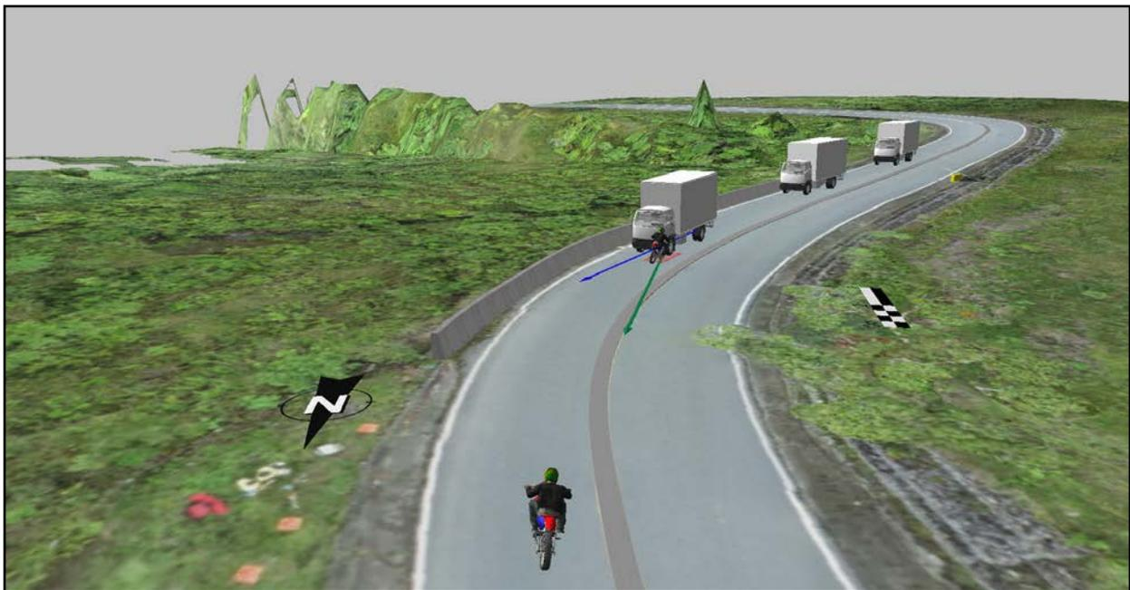
Figura 32. Posición pre-impacto y posición de los vehículos durante el impacto.
