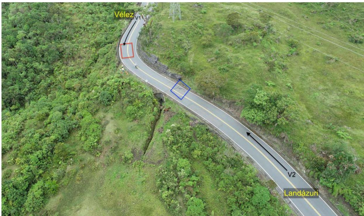
Figura 8. Panorámica de la vía con vista hacia el sur, en la trayectoria del vehículo (2) motocicleta. El recuadro azul ilustra el área de depresión en el carril de circulación de la motocicleta. El recuadro rojo ilustra el área de la posición final de los EMP y EF.
