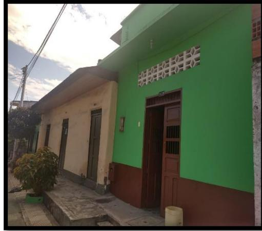
Cuenta con una puerta de madera como acceso principal que contiene reja metálica tipo ventana. Sobre la cual se tiene una celosía en ladrillo, tipo ventilación.
