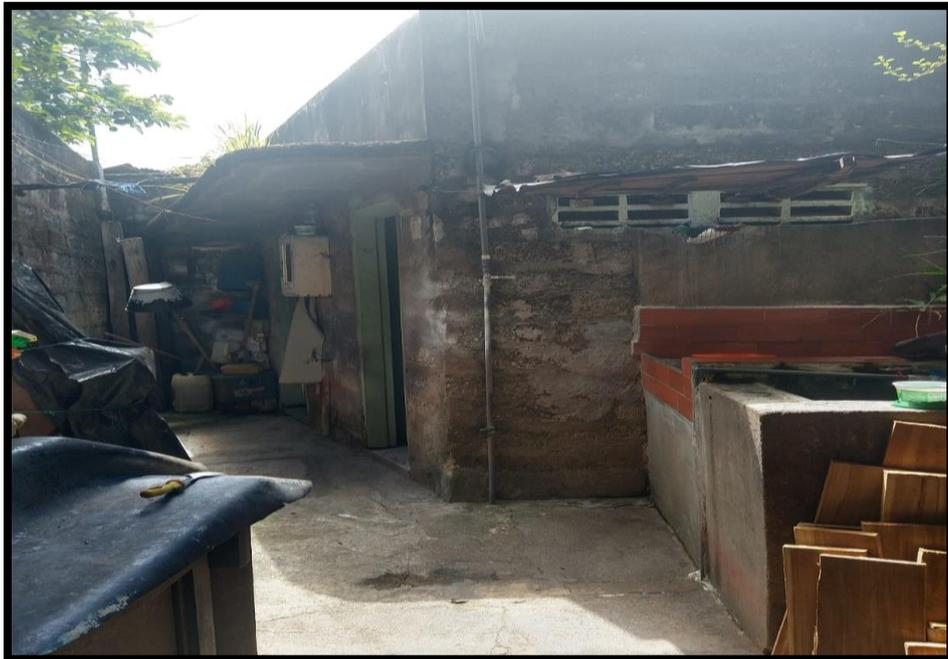
Espacio descubierto, lavadero parte enchapado en cerámica y cemento., dos áreas en una el baño con sanitario y el otro cuarto zona húmeda., en la parte superior tiene una alberca en cemento que se utiliza como tanque para almacenar agua para el baño. Los pisos de este inmueble están en cemento.
