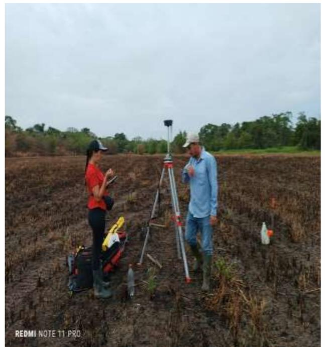
Figura 9. Toma de punto con RTK GNSS.
