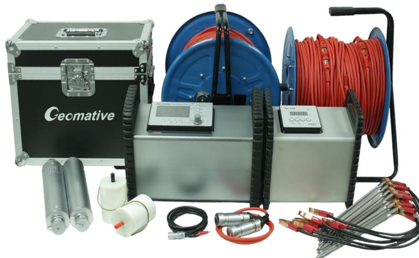
**IMAGEN 6:** Equipo de tomografía utilizado en el proyecto Edificio Kaoba.
