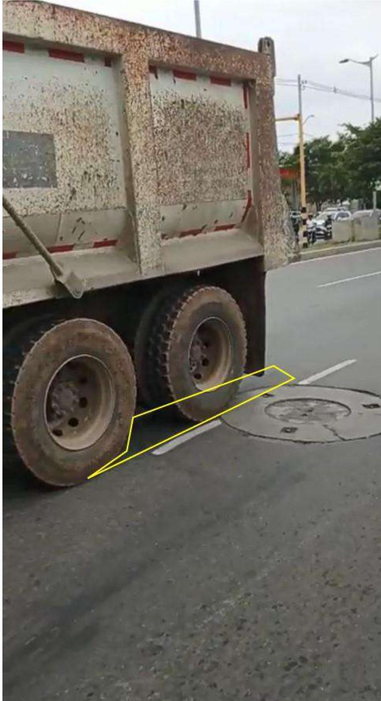
**Imagen No. 42:** En esta imagen sustraída de uno de los vídeos del día de los hechos se aprecia una huella de frenada con una longitud aproximada entre 2 y 2,5 m.
