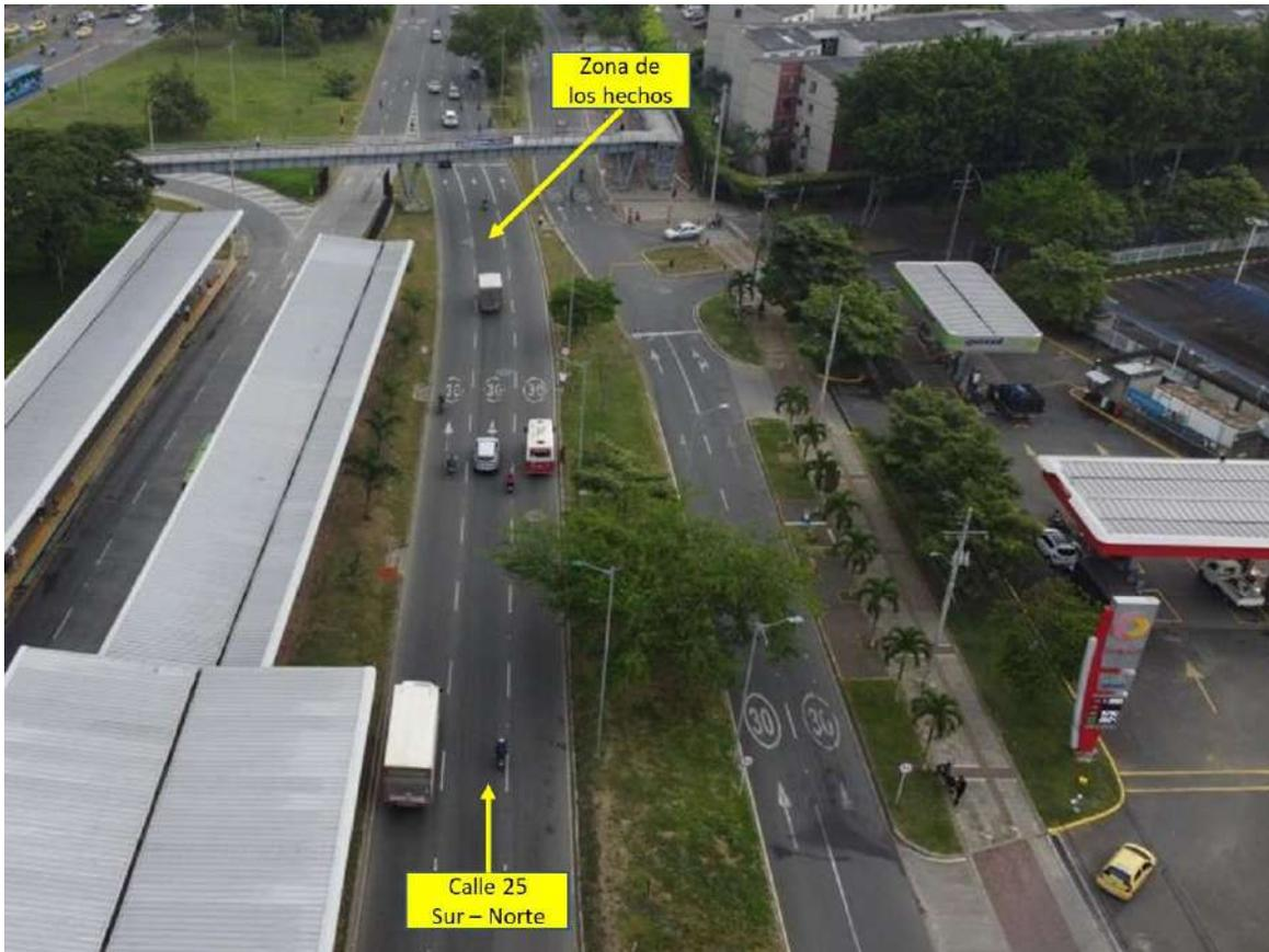
**Fotografía No. 1 Panorámica:** En esta fotografía tomada por el equipo de IRS Vial en sentido sur – norte en la calle 25 entre carreras 65 y 66, se aprecian las características generales de la vía, en la cual se encuentra demarcación horizontal de línea blanca segmentada, líneas de borde y velocidad máxima 30 km/h, con señalización vertical; en este sentido se desplazaban los vehículos.
