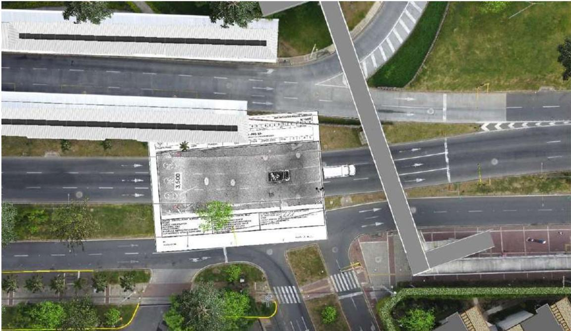
**Imagen No. 17:** En esta imagen vista en planta se aprecia el bosquejo topográfico realizado y presentado por la autoridad sobre el plano a escala levantado por el equipo de IRS Vial, en el cual se encuentra la diferencia partiendo de una medida base (ancho de carril). Elaboración a escala en el software Trimble Forensics Reveal.
