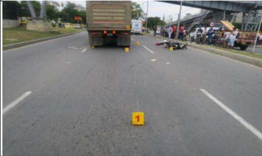
**IMAGEN No.07: PRIMER PLANO:** Fotografía judicial de fijación de la **Evidencia No1:** Huella de arrastre metálico en forma irregular dejada por la motocicleta de placas XXE-97D por el contacto con la capa asfáltica, la cual inicia en el carril central y termina sobre el carril derecho de la calle 25 calzada principal sentido sur a norte.
