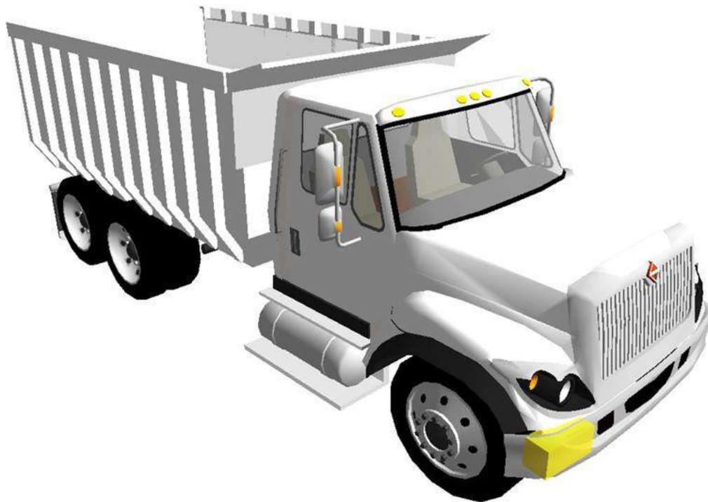
**Imagen No. 8:** En esta imagen se observa con los recuadros amarillos la ubicación de los daños o evidencia en la volqueta. Elaboración a escala en el software Trimble Forensics Reveal.
