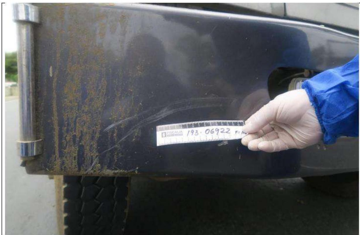
**IMAGEN No.42: PRIMER PLANO:** Fotografía judicial de verificación e inspección técnica al vehículo tipo volqueta de placas tipo volqueta de placas **TSW-826** de daños, zonas de limpieza, transferencia o de contacto sufridos en el siniestro, observando: Rayon sobre la parte media e inferior del bomper delantero costado derecho, producido por el contacto con la parrilla trasera de la motocicleta de placas **XXE-97D**.
