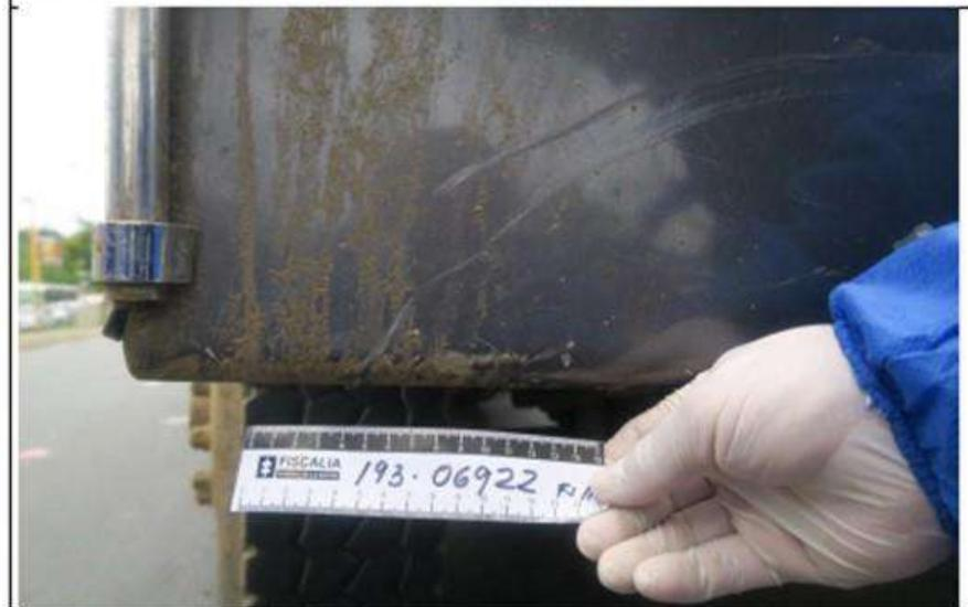
**IMAGEN No.43: PRIMER PLANO:** Fotografía judicial de verificación e inspección técnica al vehículo tipo volqueta de placas tipo volqueta de placas TSW-826 de daños, zonas de limpieza, transferencia o de contacto sufridos en el siniestro observando: Rayon sobre la parte media e inferior del bomper delantero costado derecho, producido por el contacto con la parrilla trasera de la motocicleta de placas XXE-97D.
