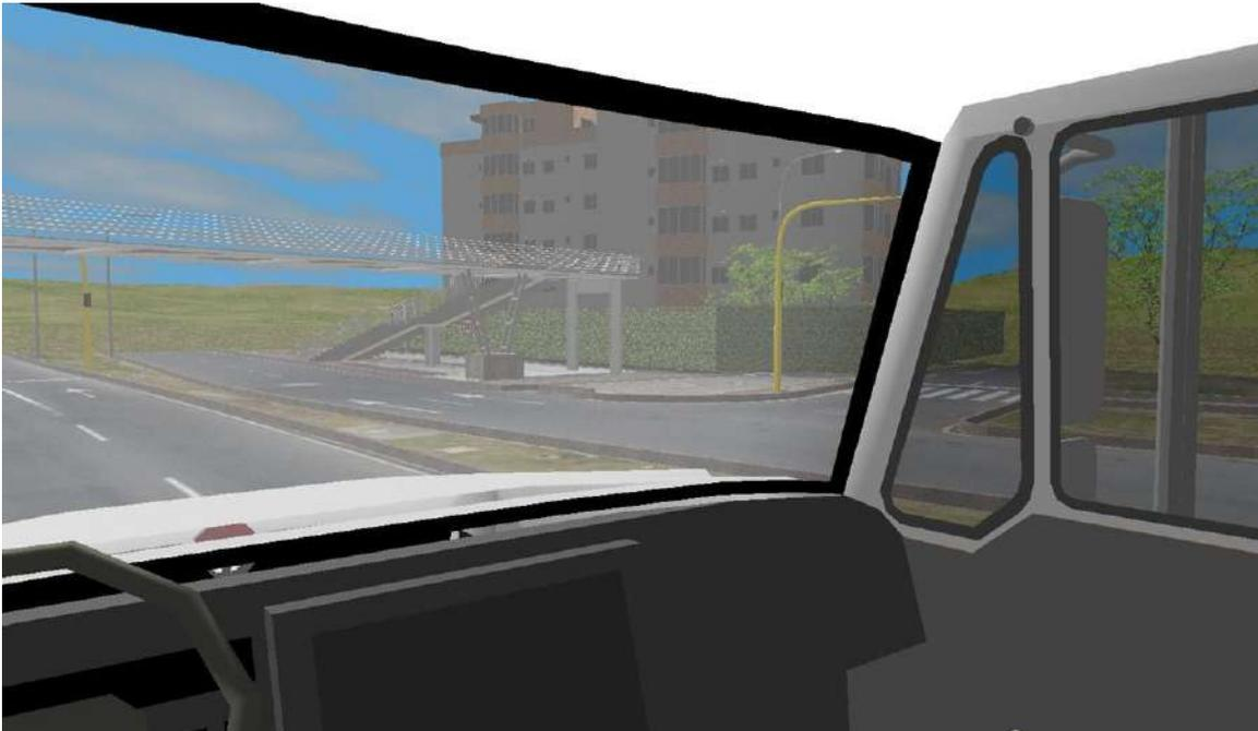
**Imagen No. 58:** En estas imágenes, vista en planta y en 3D se aprecia la visibilidad del conductor de la volqueta al momento del impacto. Elaboración a escala en el software Trimble Forensics Reveal.
