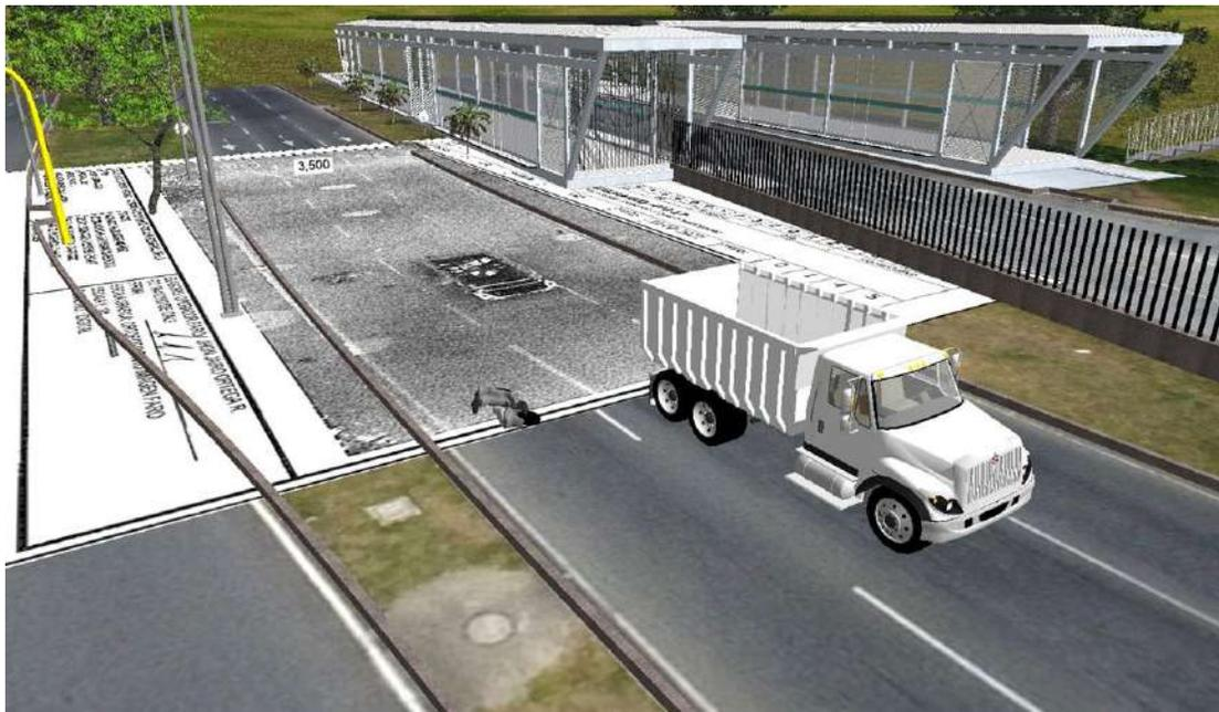
**Imagen No. 18:** En estas imágenes, vista en planta y en 3D se aprecia el bosquejo topográfico realizado y presentado por la autoridad sobre el plano a escala levantado por el equipo de IRS Vial, en el cual se encuentra la diferencia partiendo de una medida base (ancho de carril). Elaboración a escala en el software Trimble Forensics Reveal.
