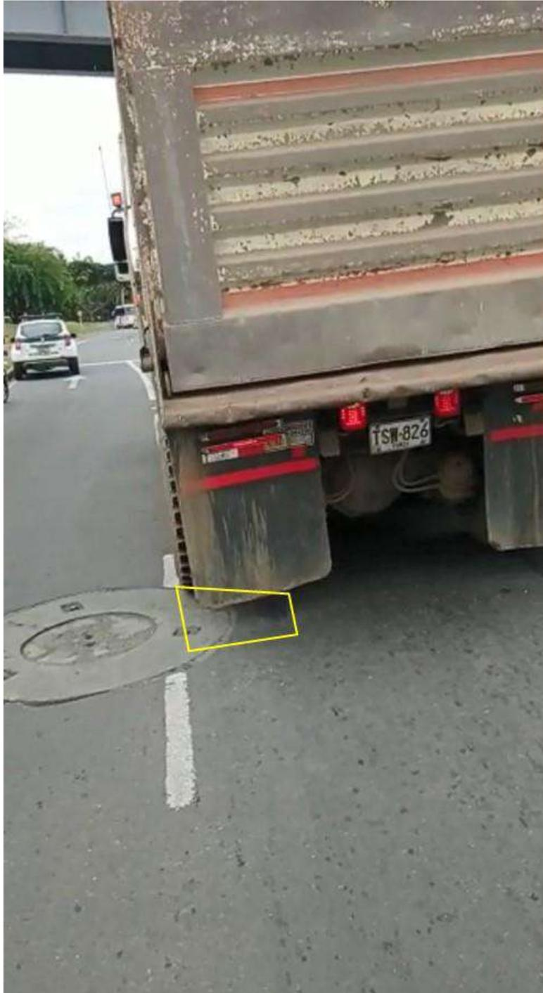
**Imagen No. 43:** En esta imagen sustraída de uno de los vídeos del día de los hechos se observa una huella de frenada con una longitud aproximada entre 2 y 2,5 m.
