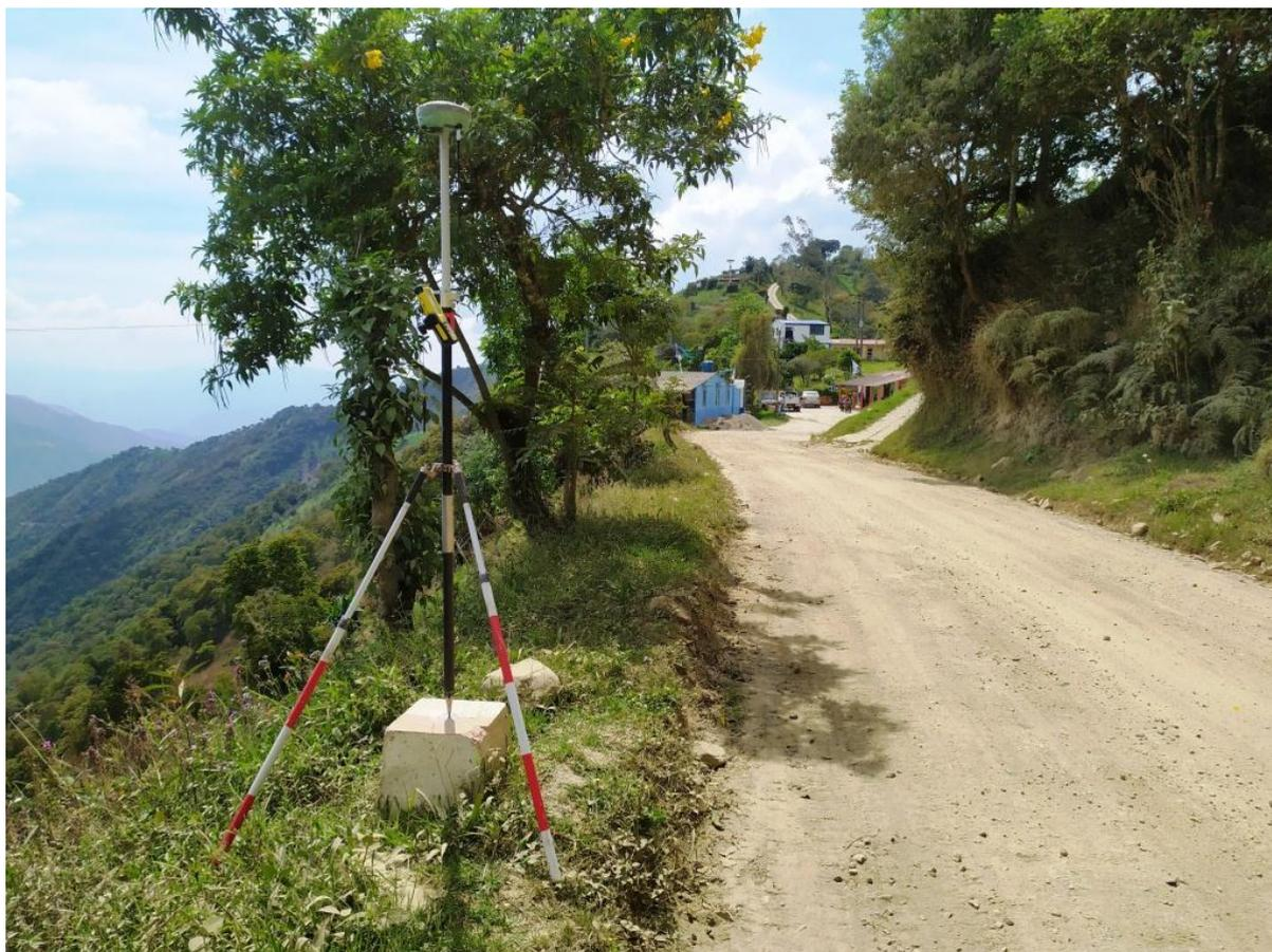
FOTOGRAFIA 4 (Puntos de Control Topográfico)
