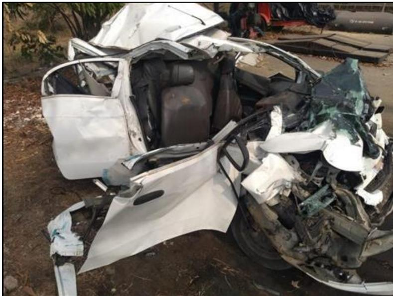
**FOTOGRAFÍAS No. 9 y 10 PLANO MEDIO:** En estas fotografías se aprecia el estado final del vehículo, el cual presenta daños en su zona anterior afectando piezas como: paragolpes anterior, unidades de luz, capó, persiana, guardabarros anterior derecho e izquierdo, puerta derecha, parales anteriores, techo, entre otras cosas. Algunos de los daños son posteriores al impacto, en el intento de sacar los ocupantes del vehículo.
