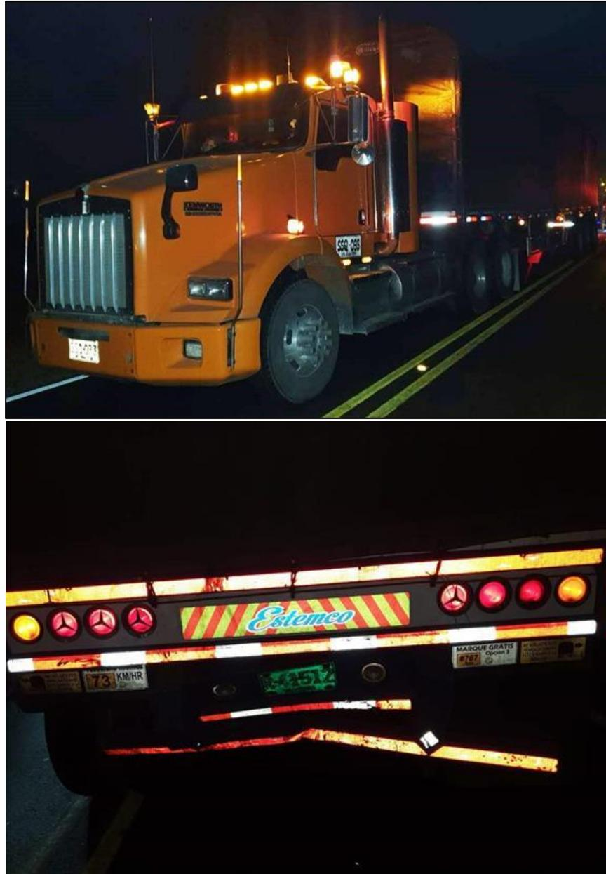
**FOTOGRAFÍAS No. 7 y 8 PLANO MEDIO:** En estas fotografías se aprecia el estado final del vehículo zona anterior izquierdo y posterior, el cual presenta daños en piezas como: bomper posterior doblado, otros daños por establecer. En las fotografías se evidencia que el impacto fue en la zona posterior del semirremolque y no en la zona anterior como lo estableció la autoridad de tránsito en el IPAT.
