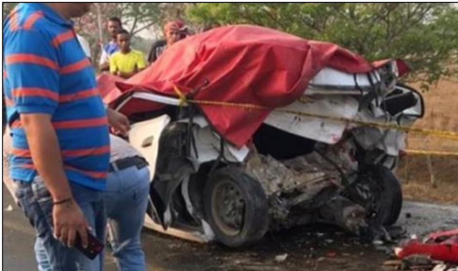
**FOTOGRAFÍAS No. 11 y 12 PLANO MEDIO:** En estas fotografías se aprecia el estado final del vehículo, el cual presenta daños en su zona posterior afectando piezas como: paragolpes posterior, unidades de luz, tapa baúl, guardabarros anterior derecho e izquierdo, puertas posteriores, parales posteriores, techo, entre otras cosas. Algunos de los daños son posteriores al impacto, en el intento de sacar los ocupantes del vehículo.
