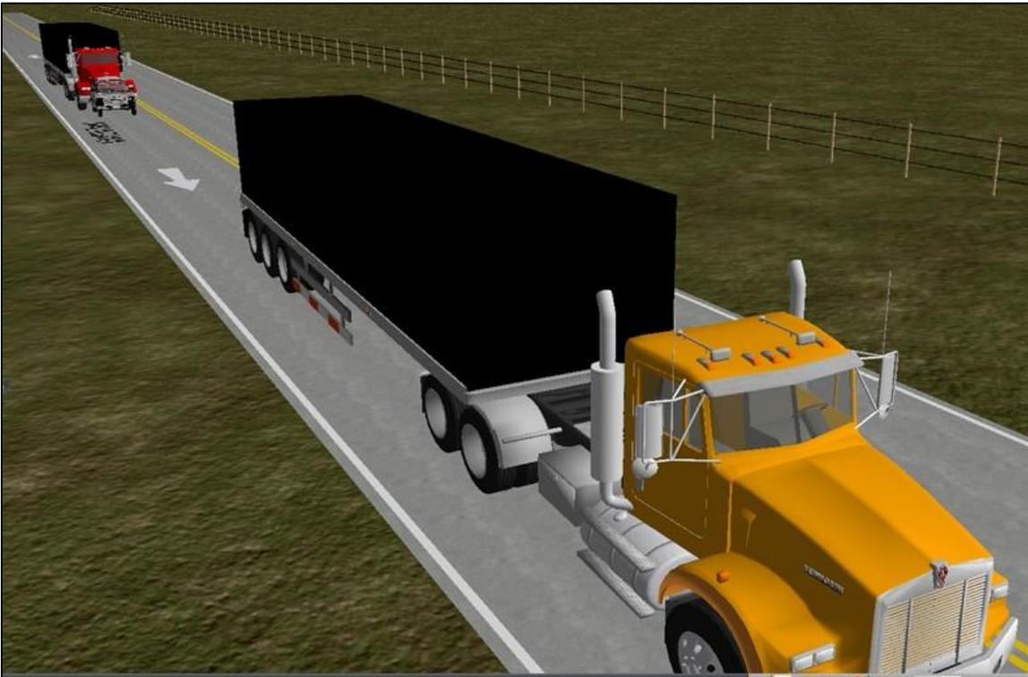
**IMÁGENES No. 35:** En estas imágenes, vista en perspectiva 3D, se aprecia la secuencia del accidente, nótese el sentido de desplazamiento de los vehículos y la posición relativa al momento del impacto y los desplazamientos hasta sus posiciones finales.
