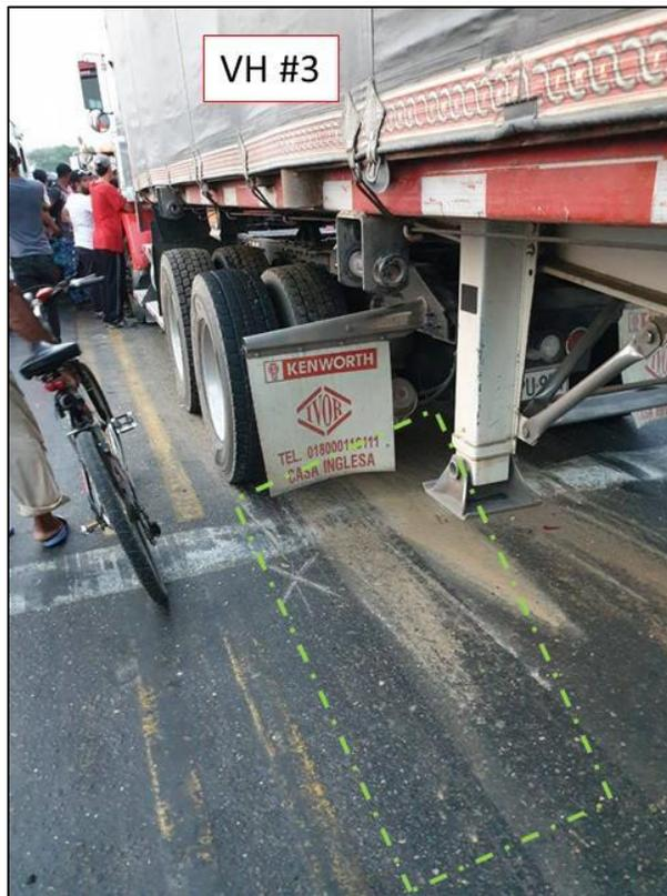
**FOTOGRAFÍAS No. 18 y 19 PANORÁMICA:** En estas fotografías se observa la ubicación de la posición final de los vehículos No. 2 y No. 3 involucrados en el accidente de tránsito. En la fotografía inferior se observa unas huellas de frenado dejadas por el vehículo No. 3 Tractocamión, que no fueron acotadas en el croquis.
