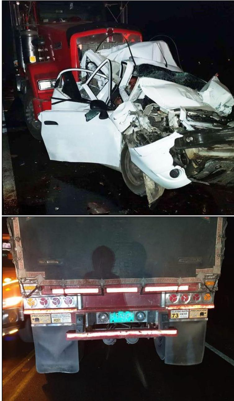
**FOTOGRAFÍAS No. 14 y 15 PLANO MEDIO:** En estas fotografías se aprecia el estado final del vehículo zona anterior derecho y posterior. En las fotografías se evidencia que el impacto fue en la zona anterior del cabezote y no en la zona posterior del semirremolque como lo estableció la autoridad de tránsito en el IPAT.
