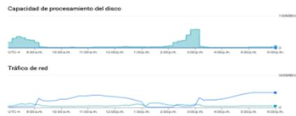
Como se evidencia en los diagramas, entre las 8 a.m. y las 6 p.m. del 2 de junio, nuestros servidores no superaron el 2% de su capacidad de procesamiento. El tráfico de red con los 3,059 discentes conectados no excedió los 25 MB por segundo, y la operación total sobre el disco de nuestro Campus Virtual, en su pico más alto, alcanzó menos de los 100 MB por segundo.
