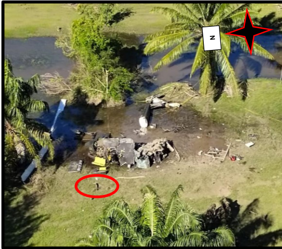
Fotografía No. 41: Punto de impacto primario palas del rotor principal PNC 0741
