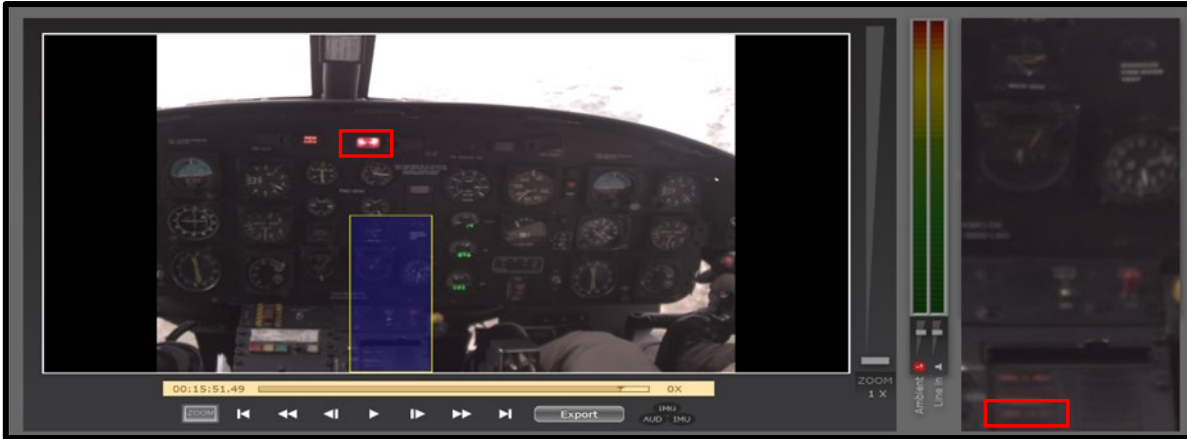
Fotografía No. 61: Se enciende luz de RPM LIMIT por sobre velocidad del rotor y se enciende luz de ENG CHIP DET en el panel de precaución.
