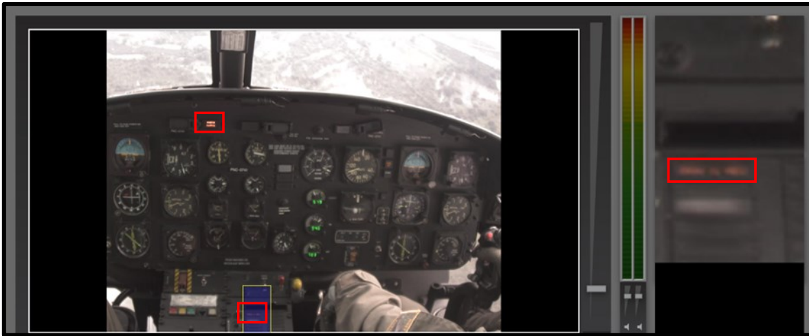
Fotografía No. 56: Se enciende luz de Master Caution como consecuencia de la caída de presión de aceite del motor y se enciende la luz de ENG OIL PRESS en el panel de precaución.
