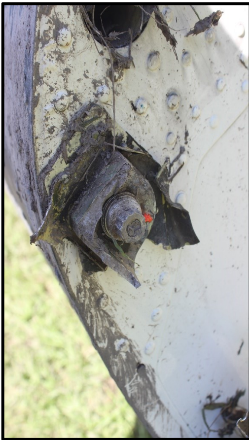
Fotografía No. 50: Vista de detalle puntos de fractura de la sección Tail Boom PNC 0741
