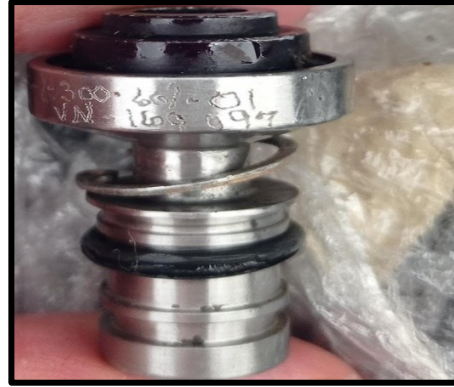
Fotografía No. 30: Vista lateral indicador de presión diferencial encontrado
