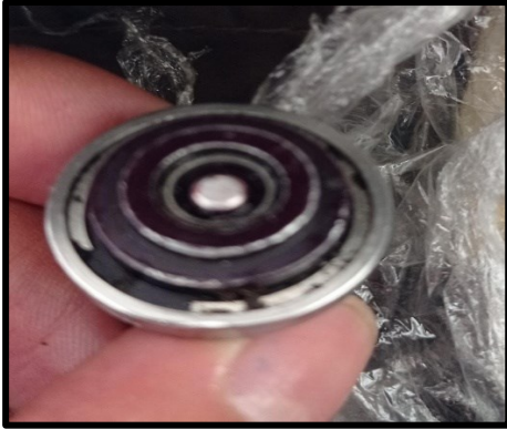
Fotografía No. 29: Vista superior indicador de presión diferencial encontrado
