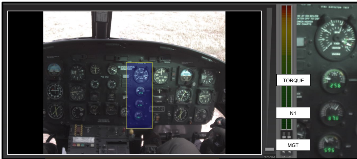
Fotografía No. 14: Anuncio de pre despegue del PNC 0741 (parámetros de estacionario)
