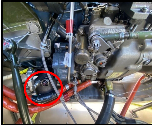
Fotografía No. 25: Imagen de REFERENCIA para ubicación del indicador de presión diferencial
