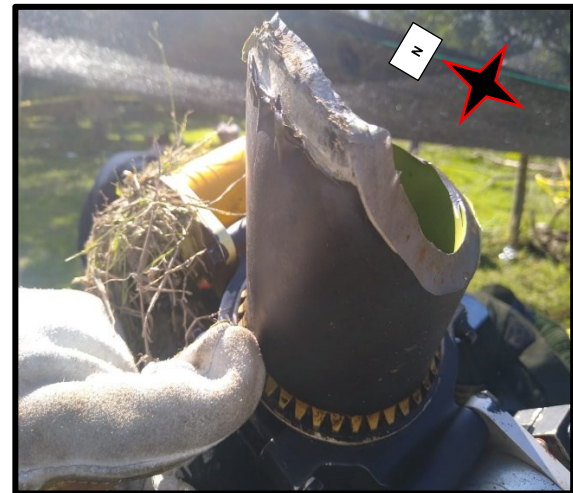
Fotografía No. 44: Detalle de la fractura del conjunto rotor al nivel del mástil del PNC 0741
