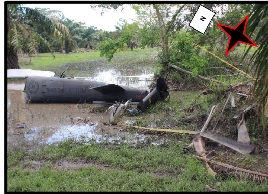
Fotografía No. 49: Vista lateral (200°) sección Tail Boom – Rotor Principal PNC 0741
