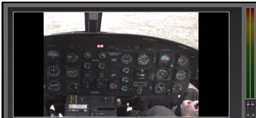
Fotografía No. 9: Encendido de la batería e inicio del sistema de grabación del equipo VISION 1000 del PNC 0941 30/05/21
