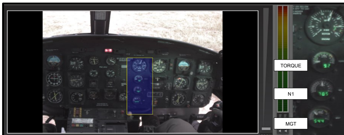
Fotografía No. 12: Aeronave PNC 0741 con parámetros de aceleración en IDLE (Mínimas) tras encendido
