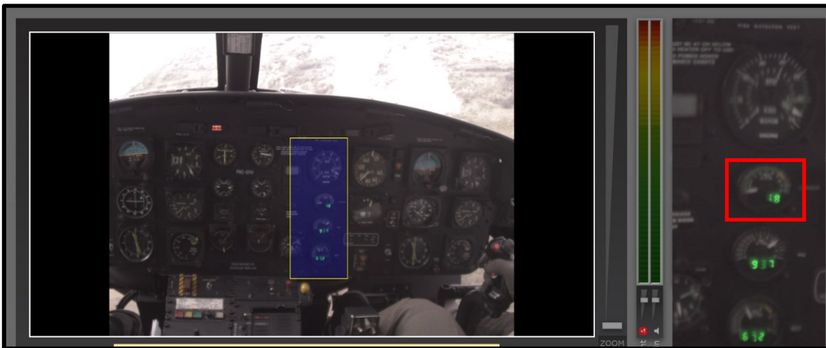
Fotografía No. 59: La indicación de torque cae y el PC reduce el acelerador llevándolo a mínimas (IDLE).
