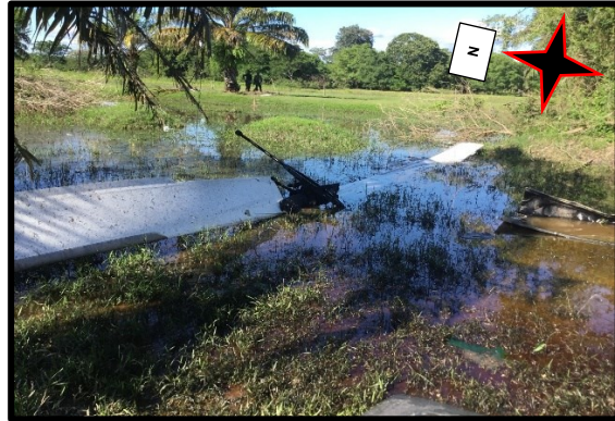
Fotografía No. 46: Detalle de la posición final del conjunto del rotor principal del PNC 0741
