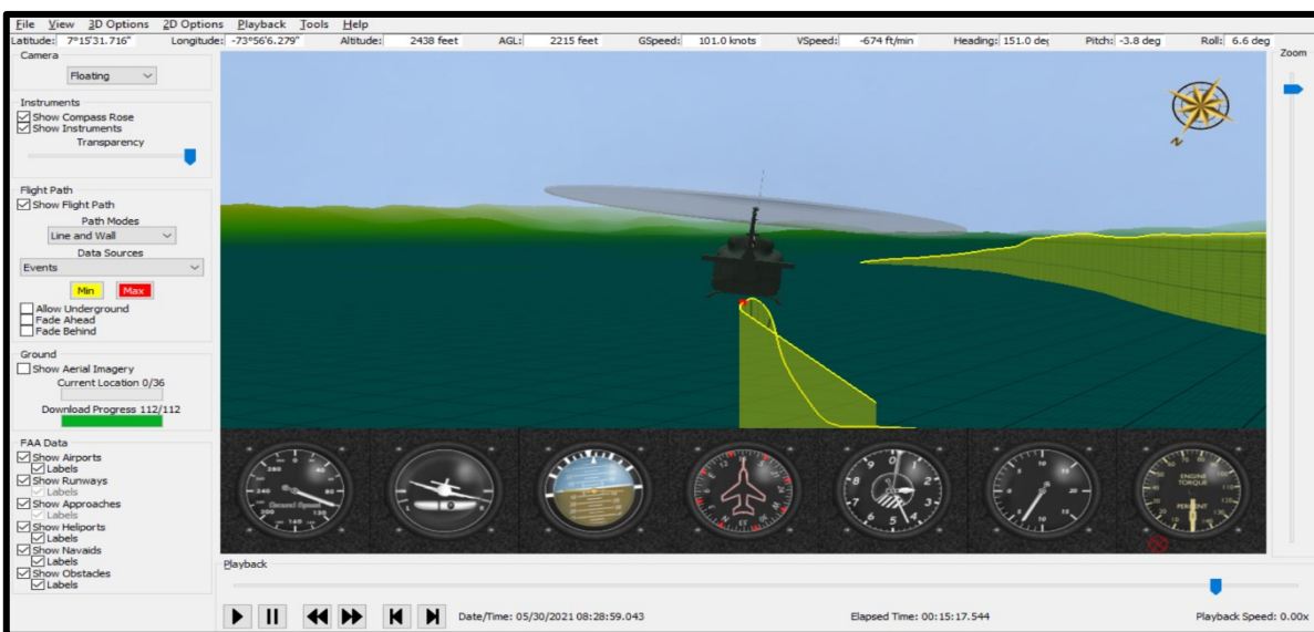
Fotografía No. 60: El PC reduce el acelerador llevándolo a mínimas (IDLE) y produce guiñada.
