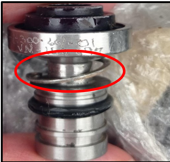
Fotografía No. 31: Referencia de ubicación del anillo de retención
