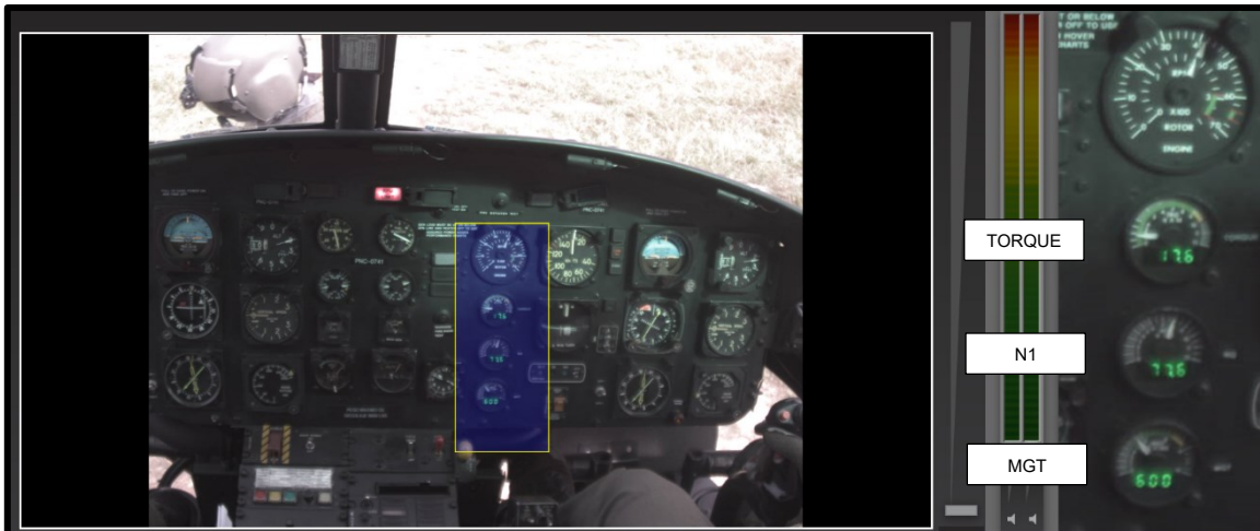
Fotografía No. 13: Inicio de procedimiento de aceleración del PNC 0741
