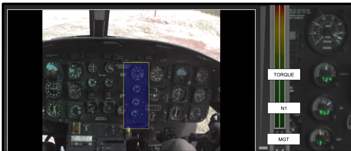
Fotografía No. 15: Parámetros de estacionario (5ft) y prueba PAC.
