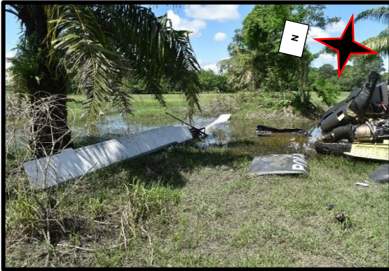
Fotografía No. 45: Plano general de la posición final del conjunto del rotor principal del PNC 0741
