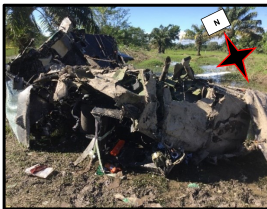
Fotografía No. 23: Afectación estructural cabina principal PNC 0741
