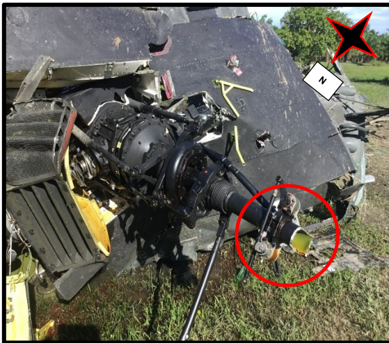
Fotografía No. 43: Punto de fractura del conjunto rotor al nivel del mástil del PNC 0741
