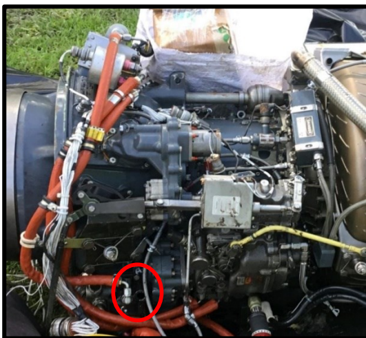
Fotografía No. 27: Carcasa del filtro de aceite del motor sin el indicador de presión diferencial
