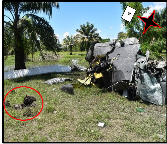
Fotografía No. 42: Detalle del punto de impacto primario del rotor principal del PNC 0741
