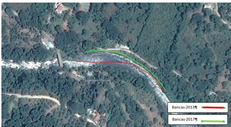
Figura 5 – Comparación del desplazamiento del eje del cauce en un lapso de 4 años para la imagen satelital del año 2017.
