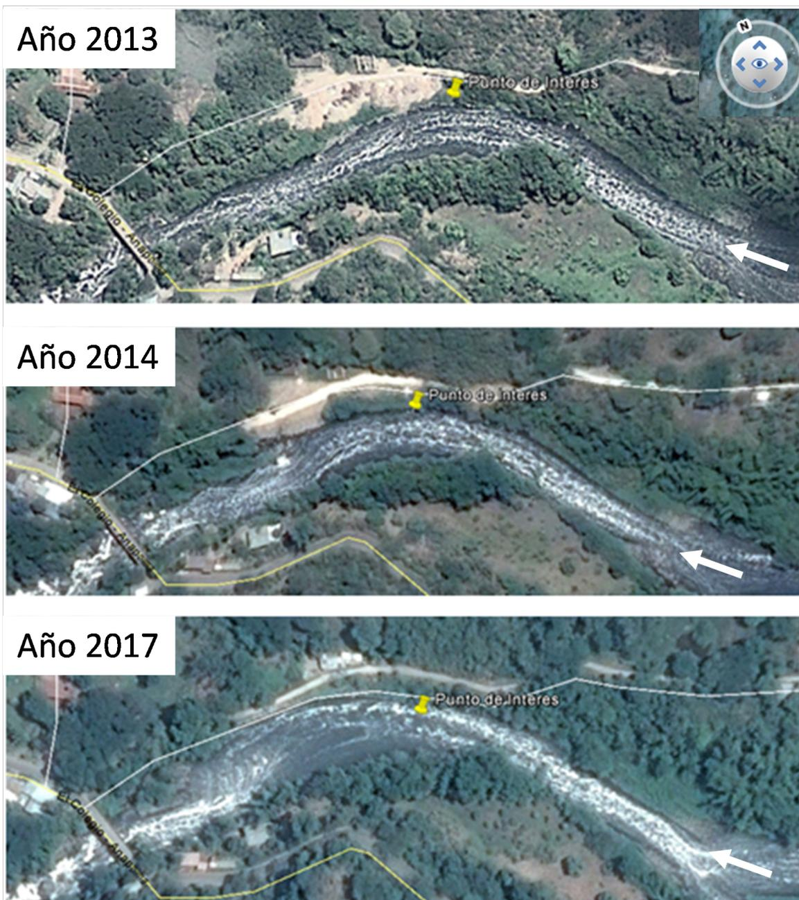
**Figura 4.** Procesos erosivos en el cauce del río Bogotá. Nótese la margen derecha del río la evolución del meandro.
