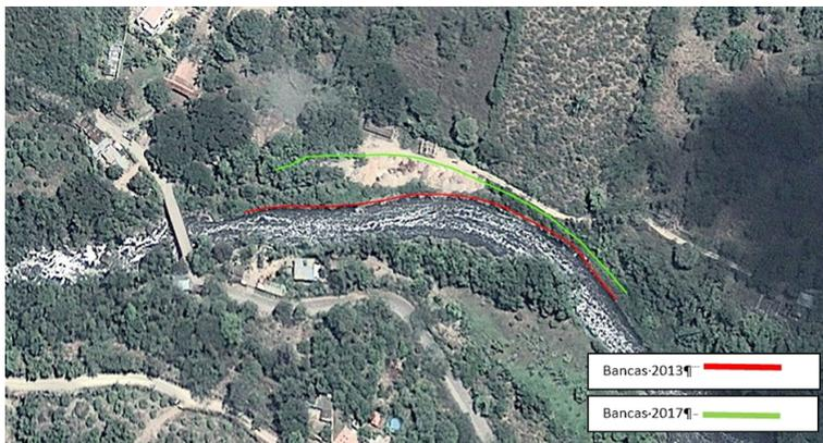
Figura 4 - Comparación del desplazamiento del eje del cauce en un lapso de 4 años para la imagen satelital del año 2017.
