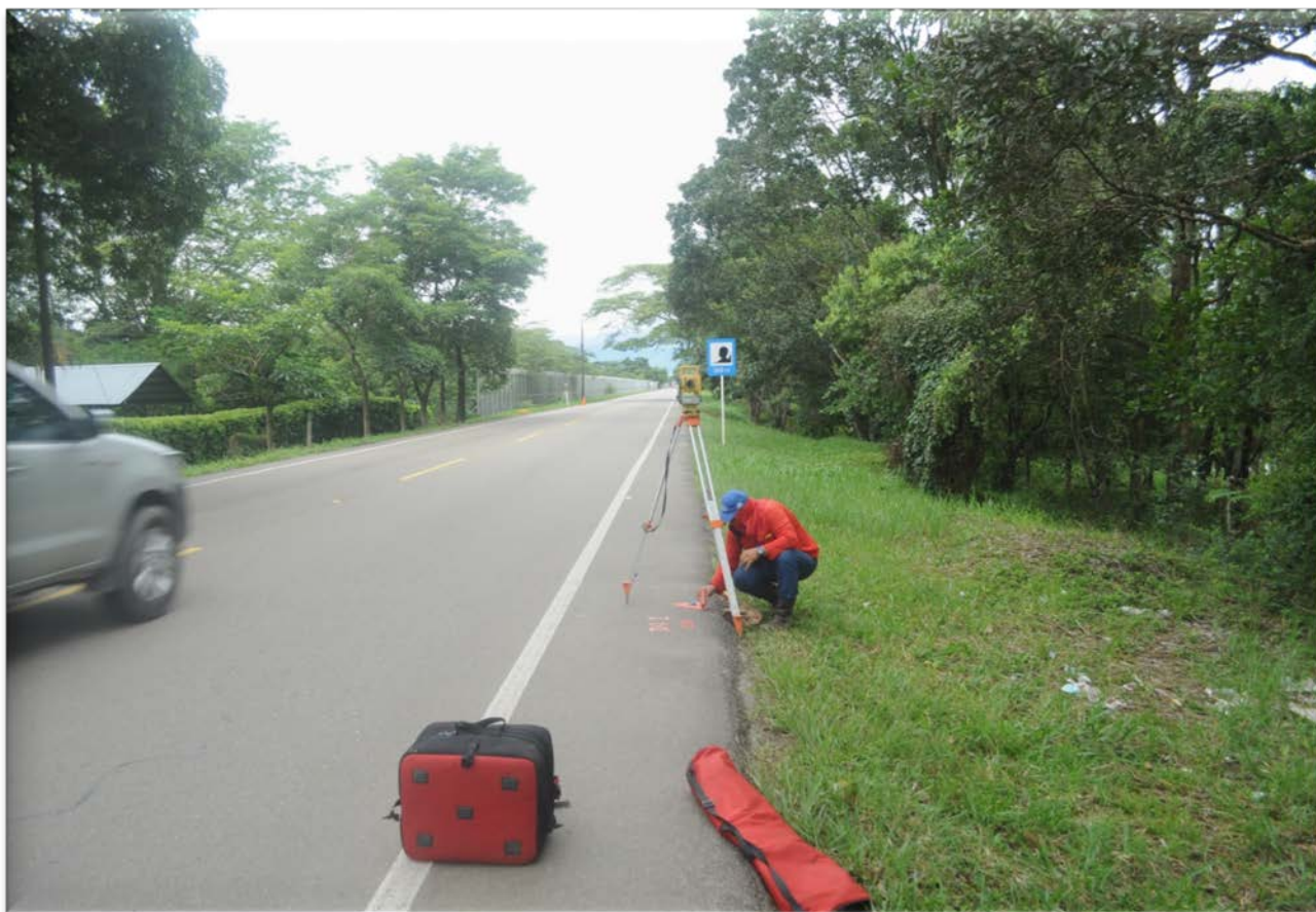
Topógrafo haciendo el levantamiento de planos con curvas de nivel y coordenadas geográficas del terreno de la finca Pequeño Bosque
