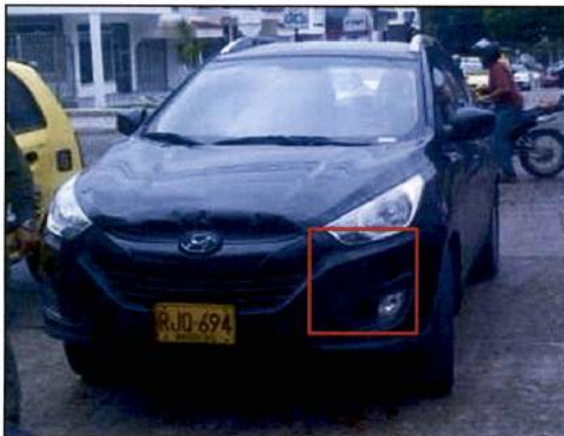
FOTOGRAFÍA No. 4 PRIMER PLANO : En esta fotografía se observa el estado final del vehículo, el cual presenta daños en su zona anterior, donde se encuentra una zona de limpieza en su vértice izquierdo afectado el paragolpes delantero.
