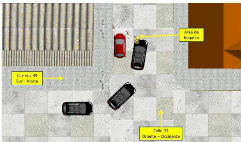
Imagen No. 19: En esta imagen vista en planta se muestra la secuencia de movimiento del vehículo y el peatón, nótese el área de impacto de color amarillo. Elaboración a escala en el software Trimble Forensics Reveal.
