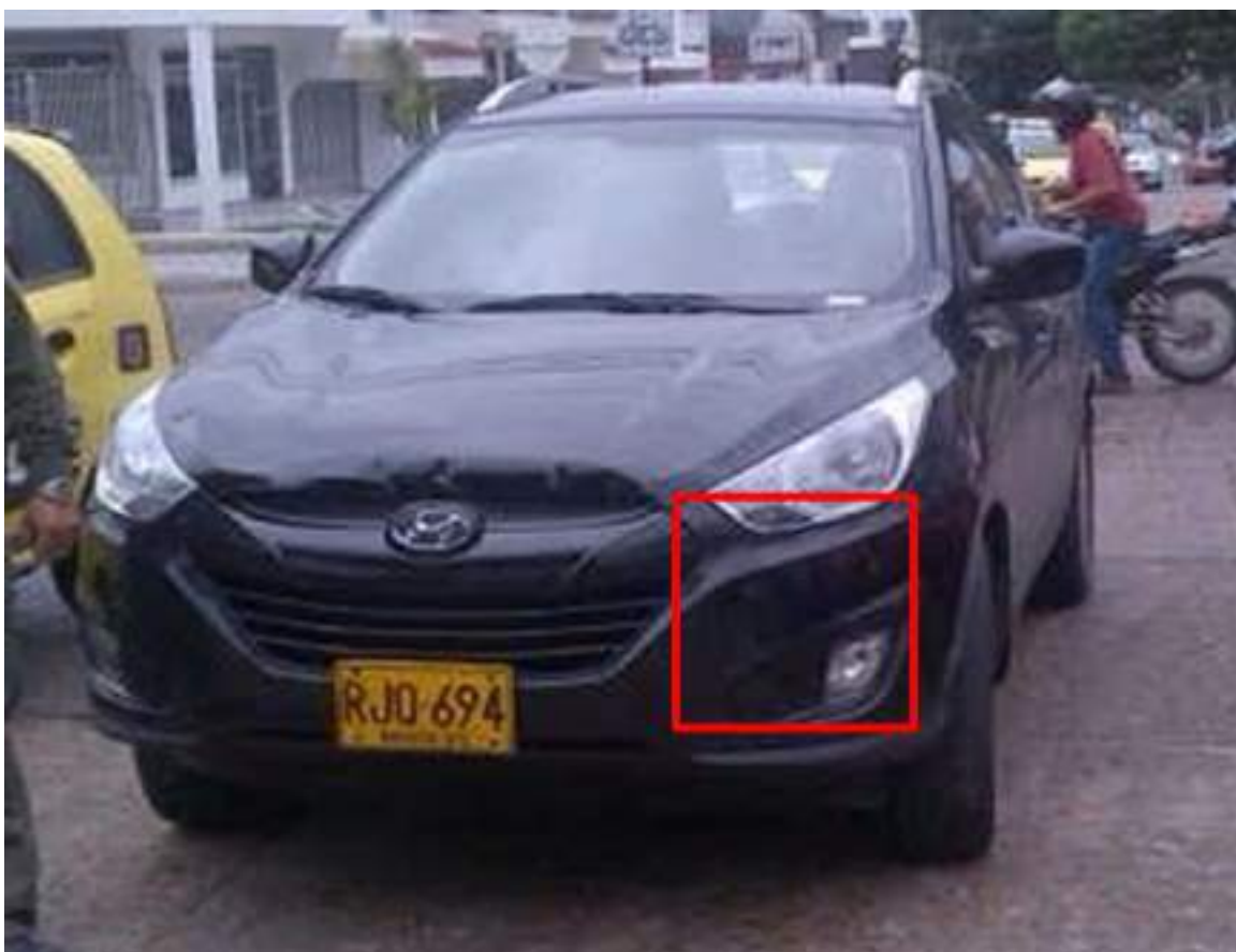
Fotografía No. 5 Primer Plano : En esta fotografía se aprecia el estado final del vehículo, el cual presenta una zona de limpieza en su vértice anterior izquierdo afectado el paragolpes delantero.
