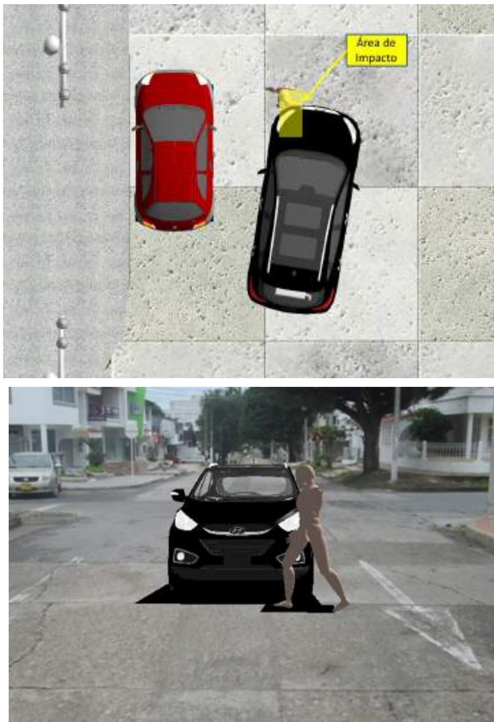
Imagen No. 17: En estas imágenes se muestra la posición relativa del vehículo al momento de la interacción y el área amarilla donde se presenta. Elaboración a escala en el software Trimble Forensics Reveal.
