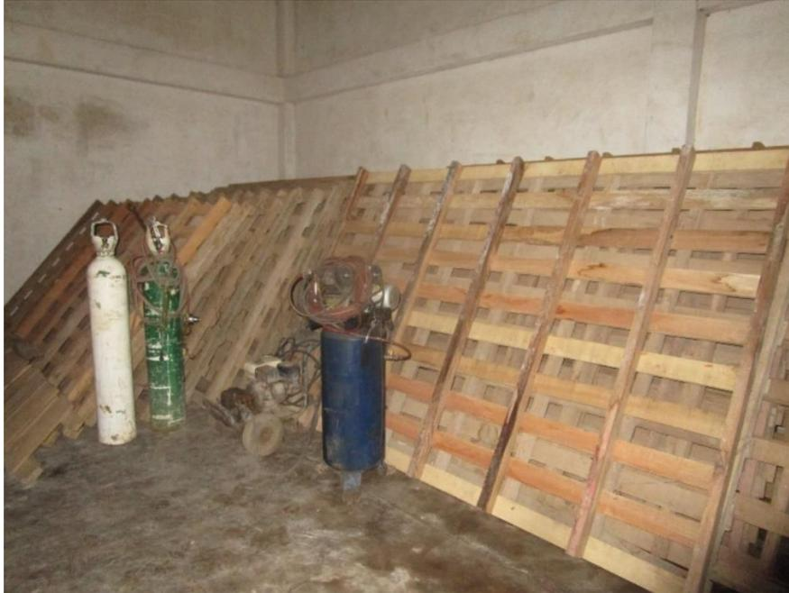
Aquí, se aprecian las estibas, que sirven de base para encarrar los bultos y aislarlos del piso, para evitar el daño a los bultos, aislarlo de posibles humedades o derrames de líquidos.
