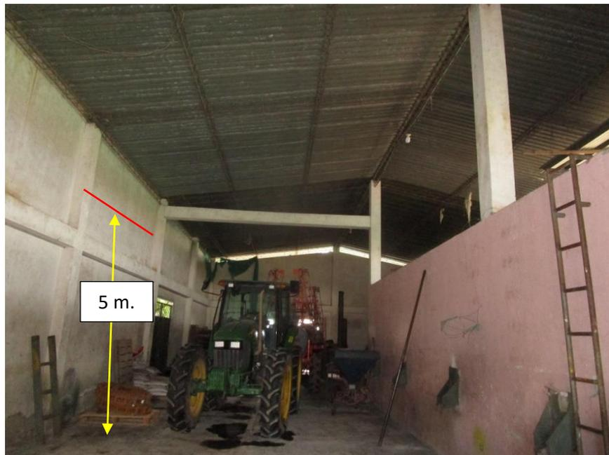
La línea roja indica el nivel de altura aproximada para un óptimo acarreo de los bultos, al fondo de la bodega (pared occidental), se pueden apreciar las ventilas para permitir el flujo de aire y así evitar el sobrecalentamiento del interior de la bodega.
